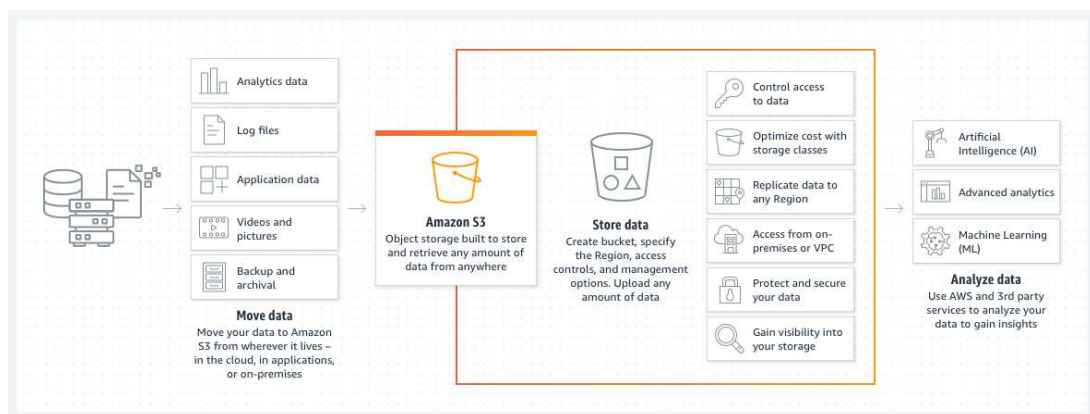
Figura 2.7: Schema di funzionamento di Amazon S3
