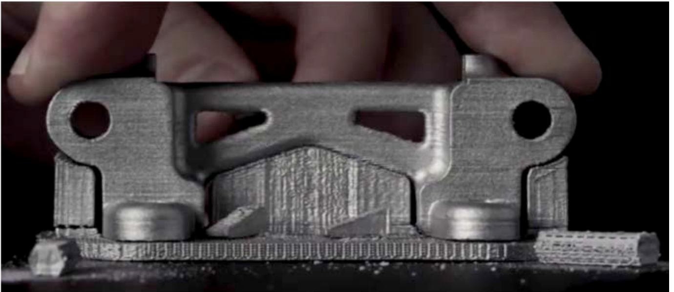
Figura 3.6A: parte green con supporto ceramico.
