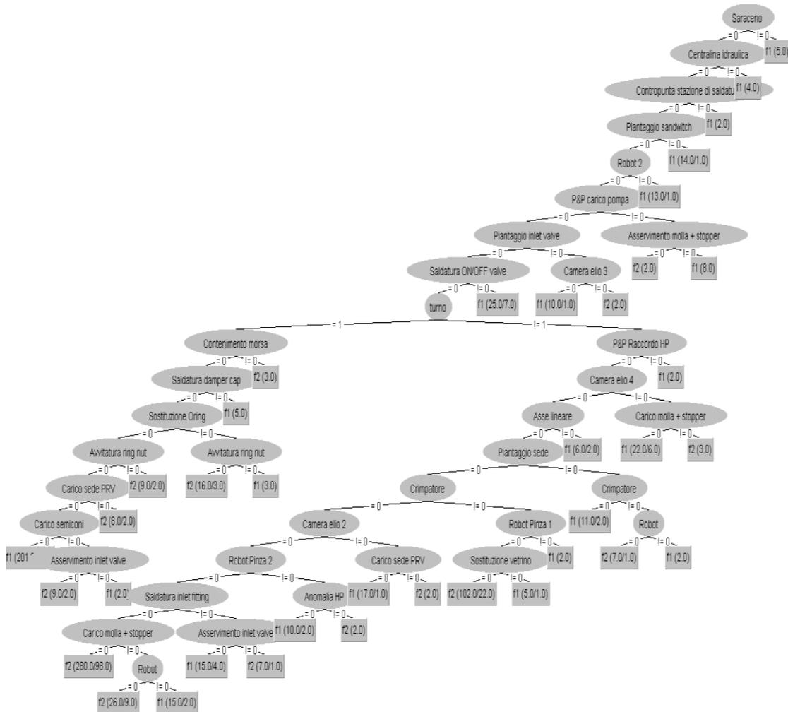
Si tratta di un albero di tipo binario in cui nell'effettuare lo splitting si valutano esclusivamente due condizioni, cioè (uguale a zero) se il guasto si verifica, (!=0, diverso da zero) se il guasto non si verifica. Ciò è ottenuto impostando su TRUE il parametro Binary splits.
