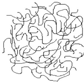
Figura 44-Disposizione delle macromolecole all'interno di un polimero amorfo [51]
