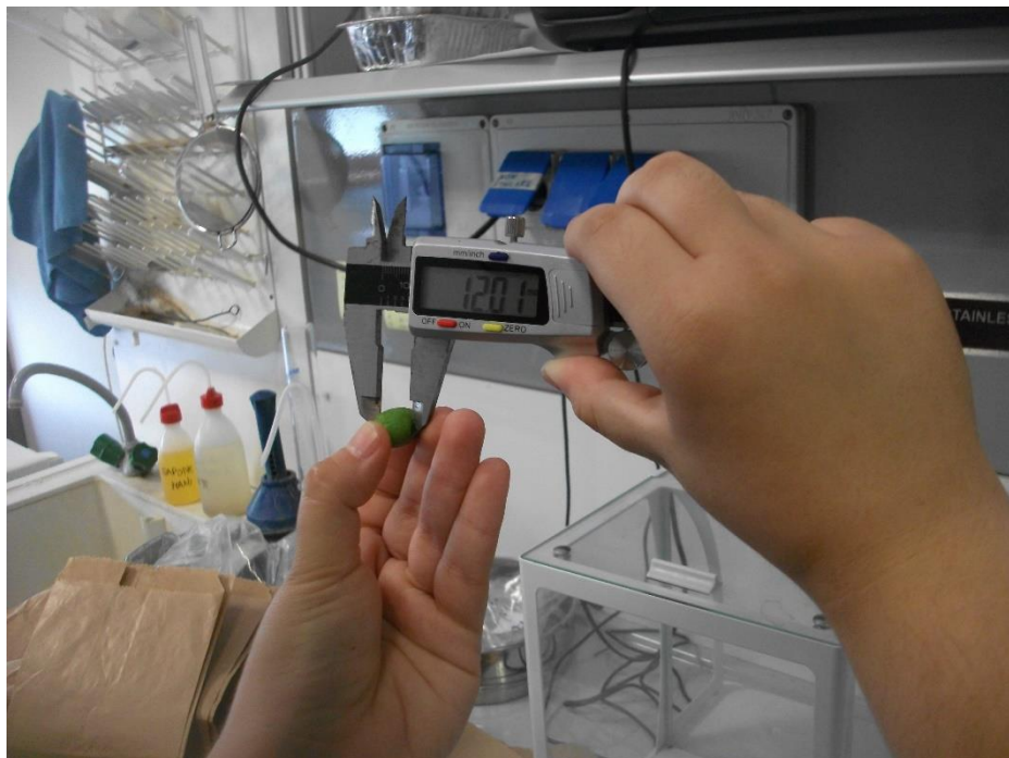
Figura 5: Calibro utilizzato per misurare i diametri dei frutti.
