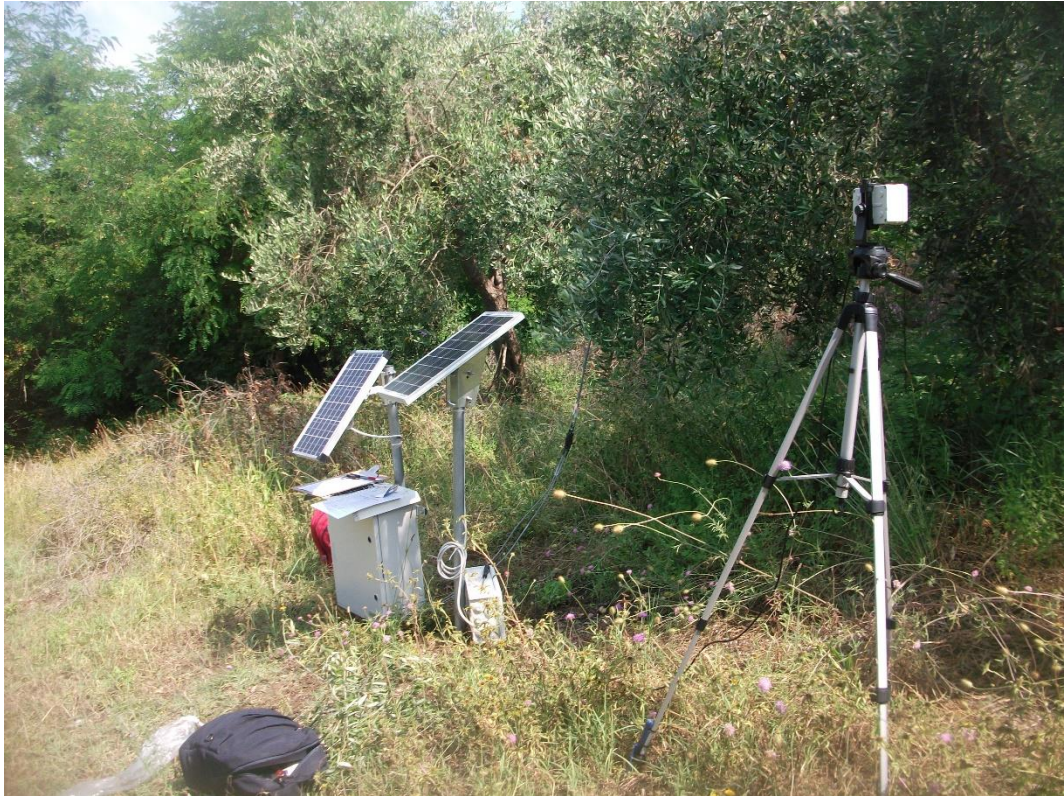
Figura 9: Dendrometro DEX70 posizionato nel campo sperimentale assieme alla fotocamera e ai pannelli fotovoltaici.
