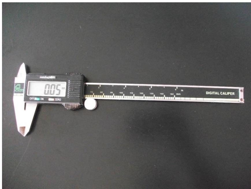
Figura 3: Calibro utilizzato per misurare i frutti di olivo.
