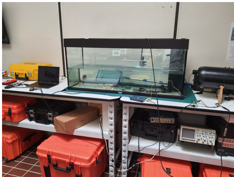
Figura 24 : A destra è presente mini-pc, schermo con tastiera e powerbank di alimentazione, al centro la vasca con l'idrofono collegato al picoscopo
