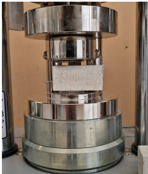
Figura 25: Macchina per prova di compressione
