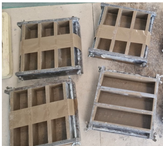
Figura 16: Casseri in acciaio rivestiti con nastro adesivo
