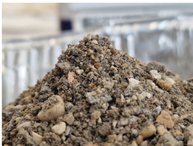
Figura 13: Prova del castelletto sabbia silicea
