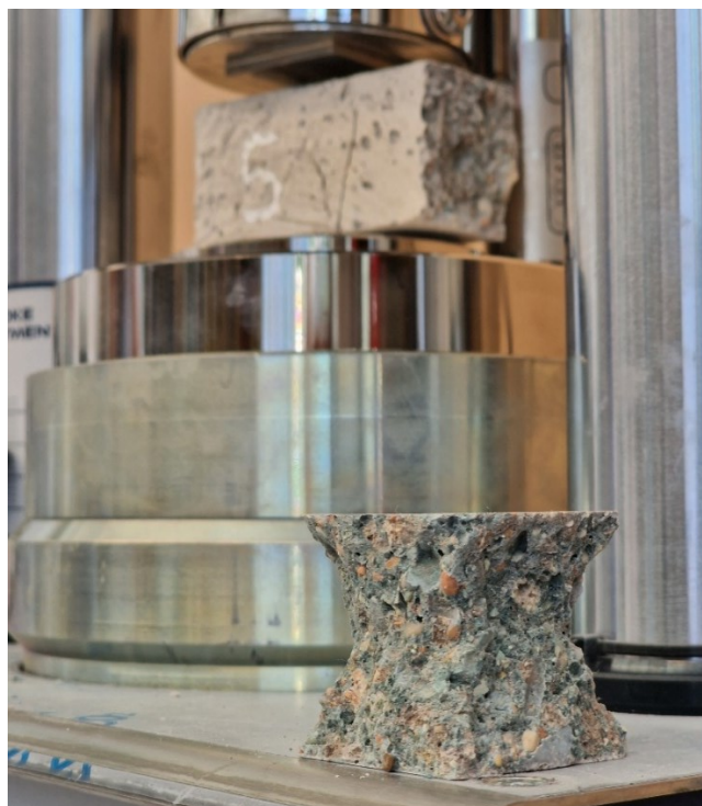
Figura 26: Provino rotto a compressione con tipica forma a clessidra
