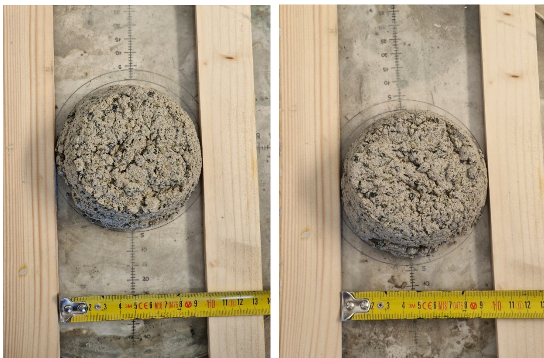
Figura 21: Slump test Getto B
