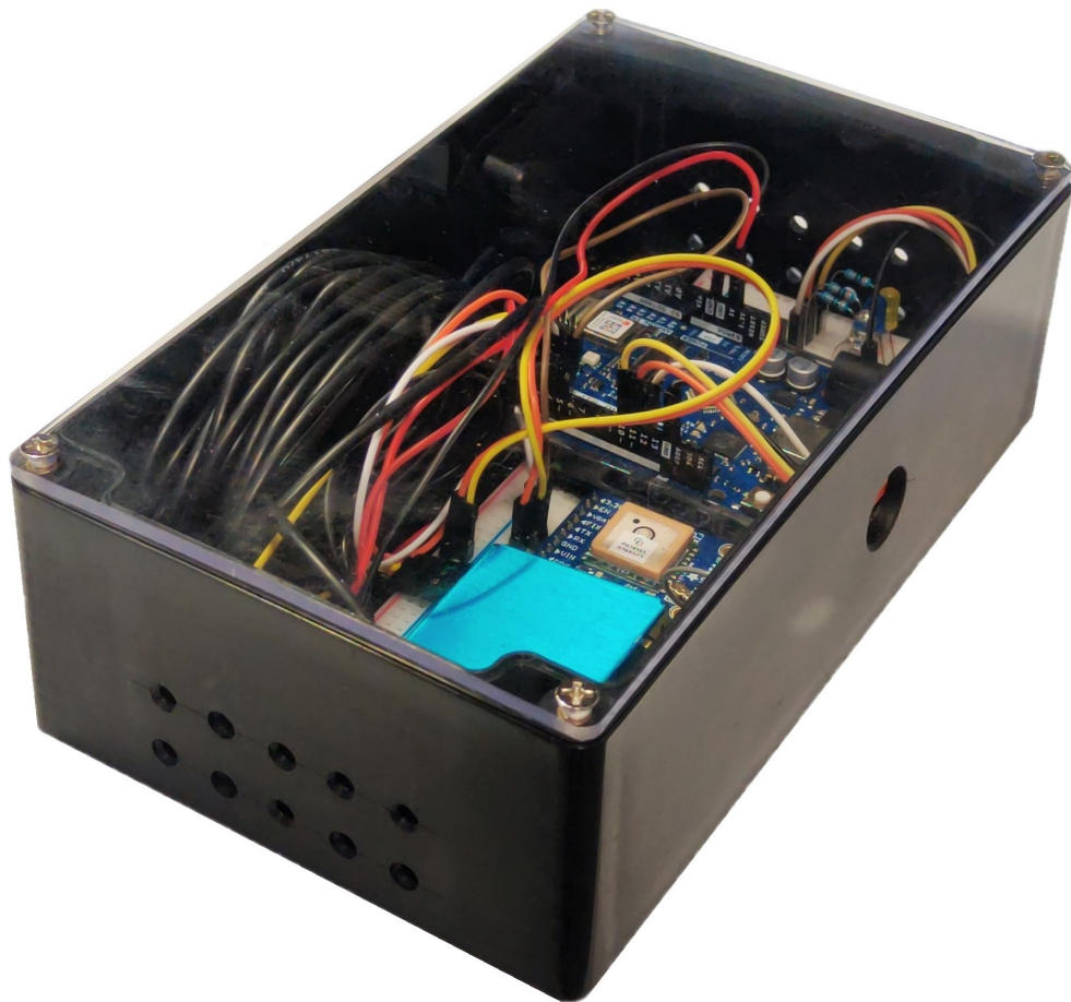
Figura 3.9: Foto della scatola chiusa con pannello in plexiglass
