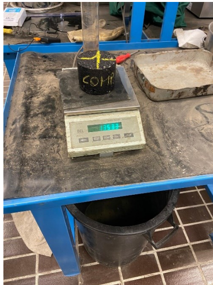
Fig. 3.21 – Provino su bilancia idrostatica ( m_1 )
