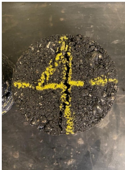
Fig. 3.31 – Provino rotto con la prova a trazione indiretta
