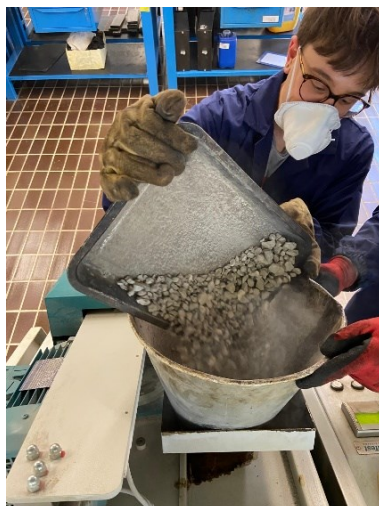
Fig. 3.7 – Inserimento degli aggregati
