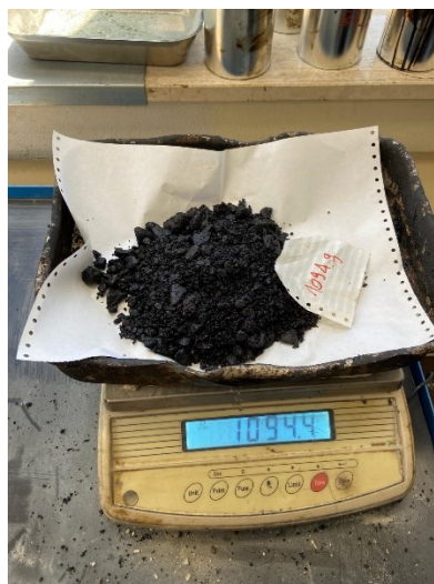
Fig. 3.10 – Conglomerato bituminoso pesato dopo la miscelazione
