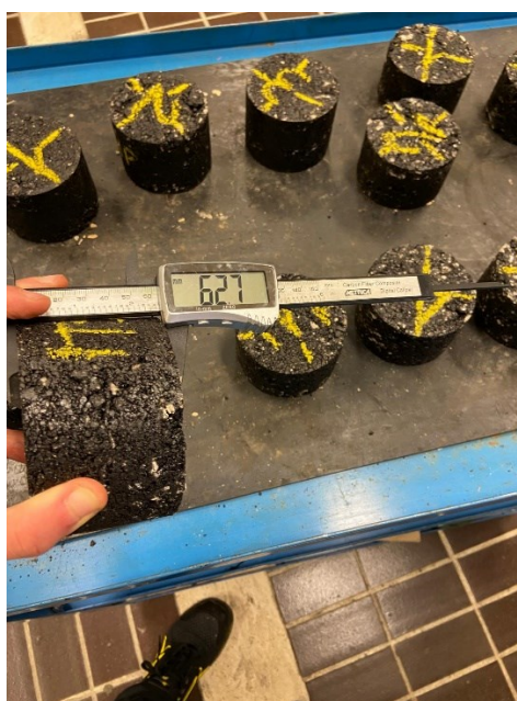
Fig. 3.23 – Determinazione altezza dei provini
