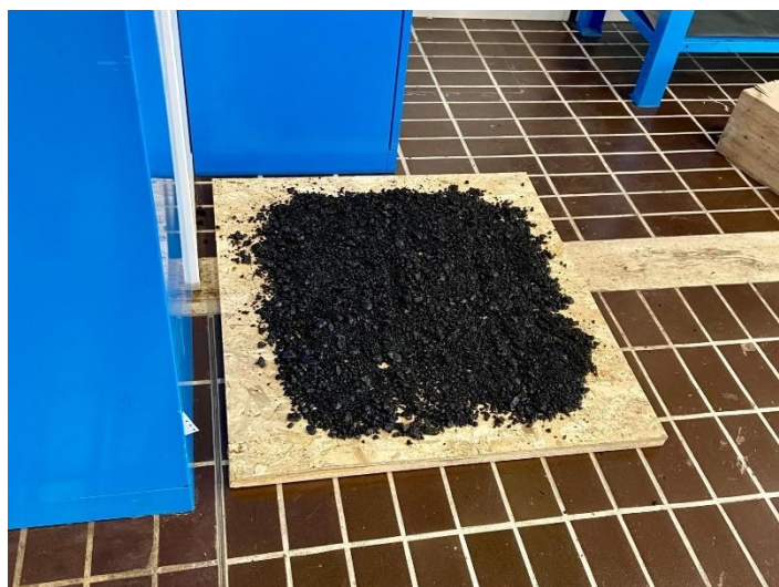
Figura 2.13 – Conglomerato bituminoso prodotto in laboratorio
