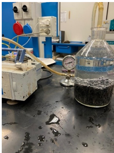
Fig. 3.3 – Picnometro sottoposto a un vuoto parziale
