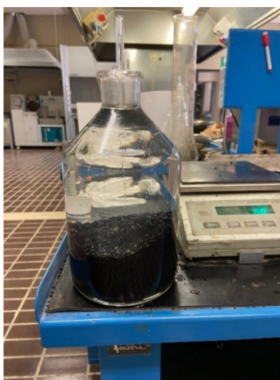
Fig. 3.4 – Pesata del picnometro, materiale e acqua ( m_3 )
