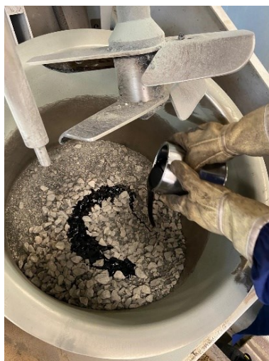
Fig. 3.8 – Inserimento del bitume
