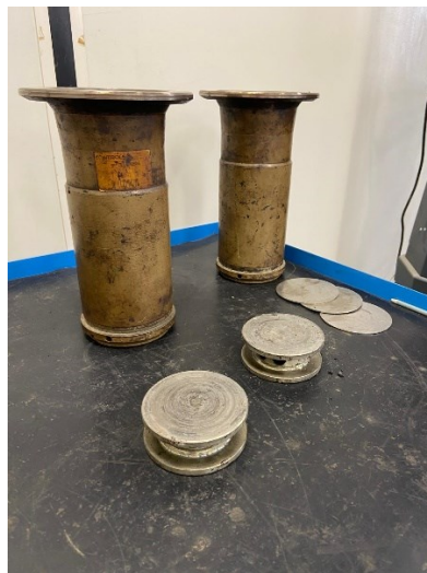
Fig. 3.14 – Fustella diametro 100 mm e spessore interno 38 mm
