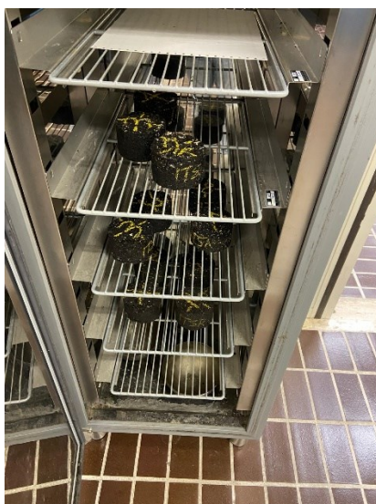
Fig. 3.27 – Condizionamento provini in camera climatica
