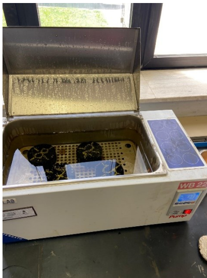
Fig. 3.26 – Provini immersi in bagno termostatico
