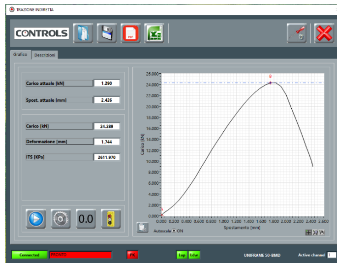
Fig. 3.32 – Curva carico-spostamento registrata dal software
