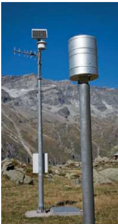
Figura 4- 2 Esempio di stazione pluviometrica
