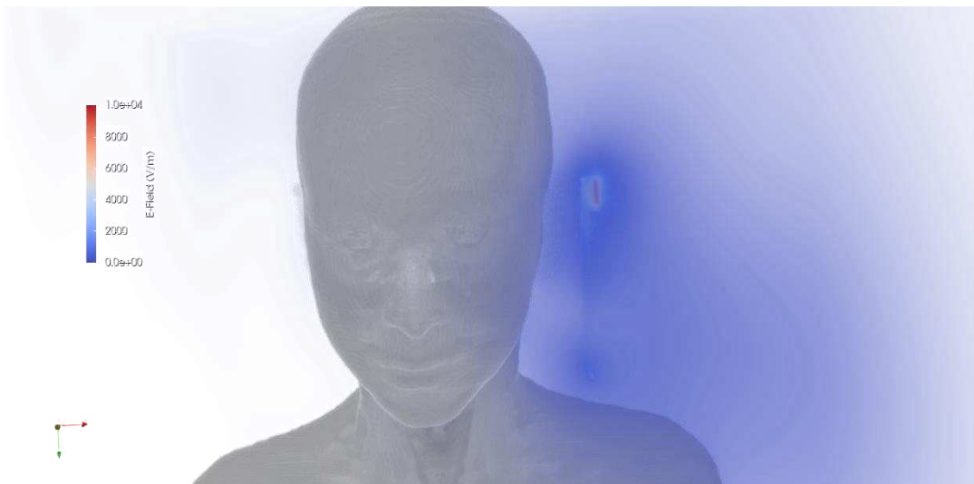
Figura 5.2.1: Distribuzione dei campi elettromagnetici sulla testa
