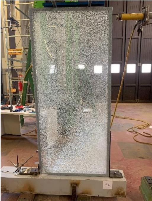
**Figura 55.** Stato di collasso vista frontale prova 5
