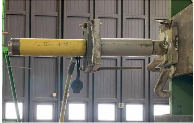
**Figura 21.** *Martinetto idraulico per carico orizzontale*
