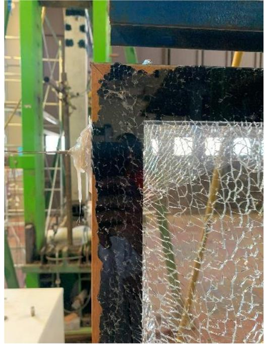
**Figura 49.** Dettaglio di rottura del vetro prova 3
