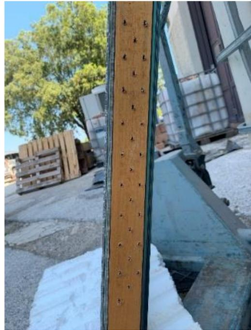
**Figura 40.** Dettaglio di rottura del telaio del pannello prova 4
