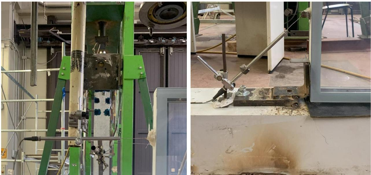
**Figura 19.** Trasduttori di spostamento e di rotazione
