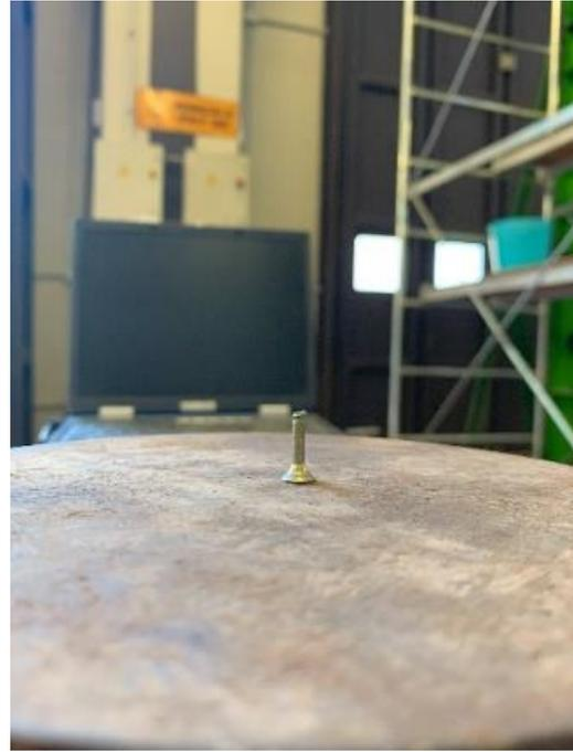
**Figura 38.** Dettaglio di rottura della vite di fissaggio prova 4
