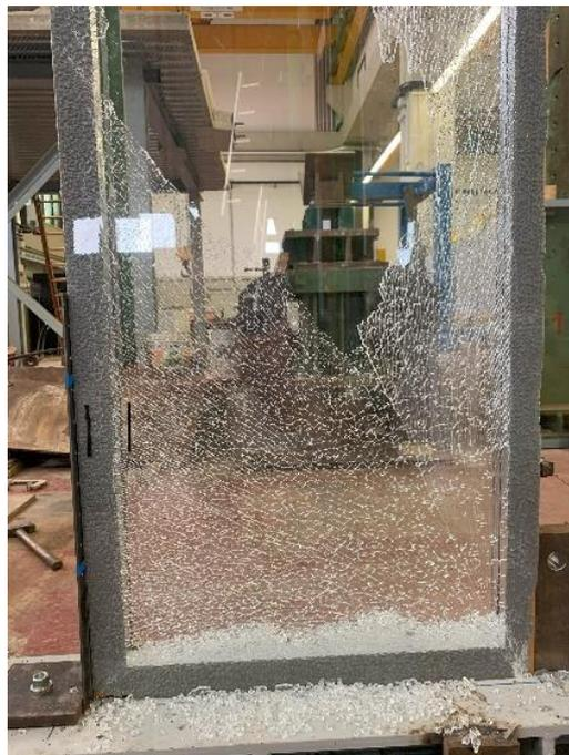
*Figura 47. Dettaglio di rottura del vetro prova 2*
