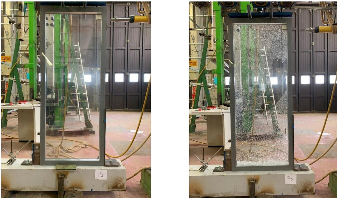
**Figura 24.** Prova sperimentale 2 pre e post rottura
