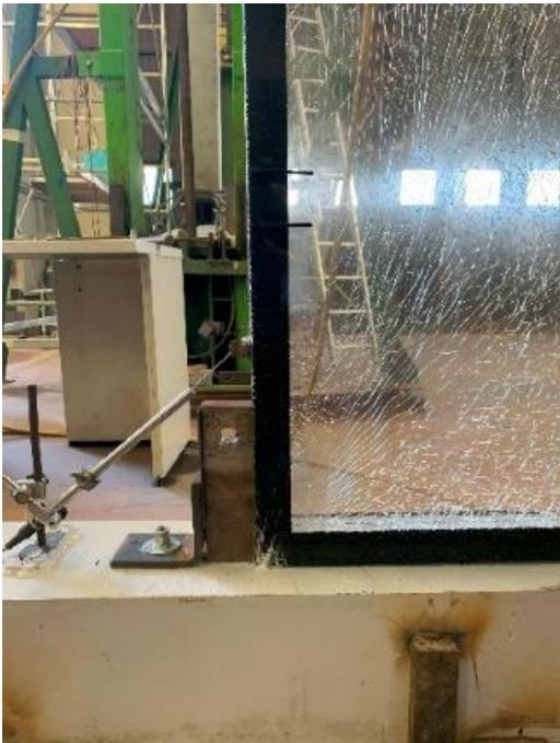
**Figura 35.** Dettaglio di rottura del vetro prova 4
