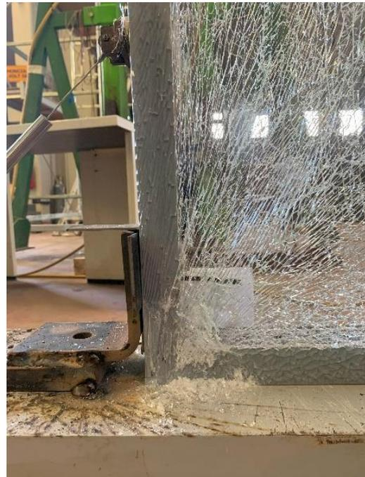
**Figura 58.** Dettaglio di rottura del vetro prova 5
