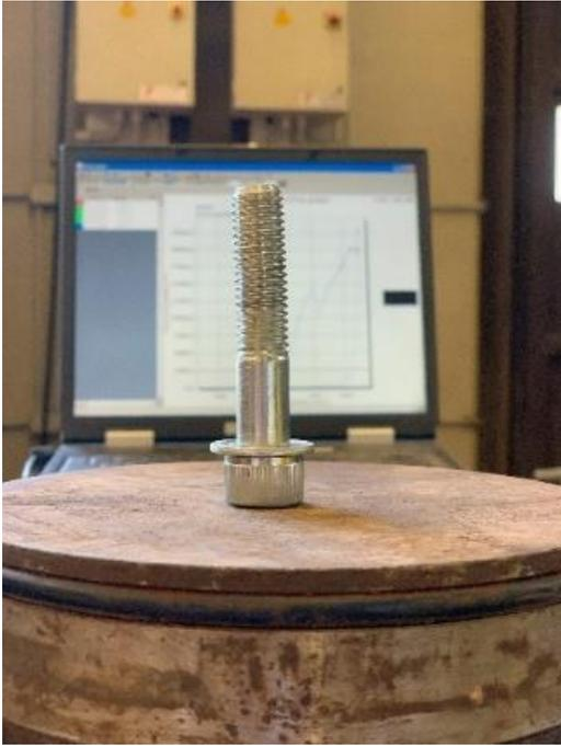
**Figura 37.** Dettaglio di piegatura della vite di fissaggio prova 4
