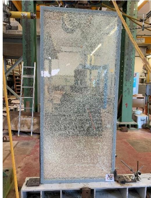
**Figura 56.** Stato di collasso vista retro prova 5
