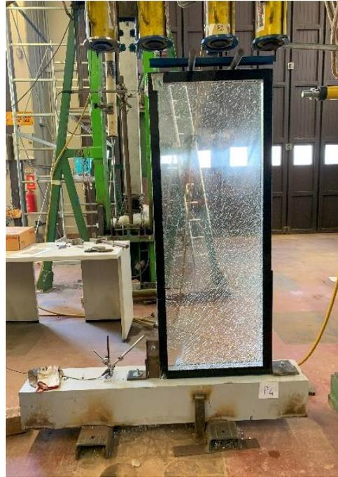
**Figura 34.** Stato di collasso prova 4
