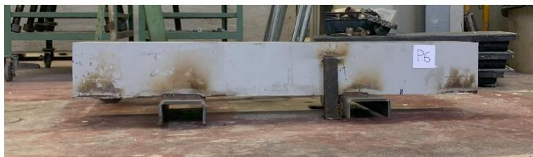
*Figura 15. Supporto di base in acciaio S235*
