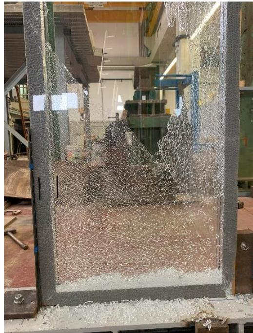
*Figura 46. Dettaglio di rottura del vetro prova 2*
