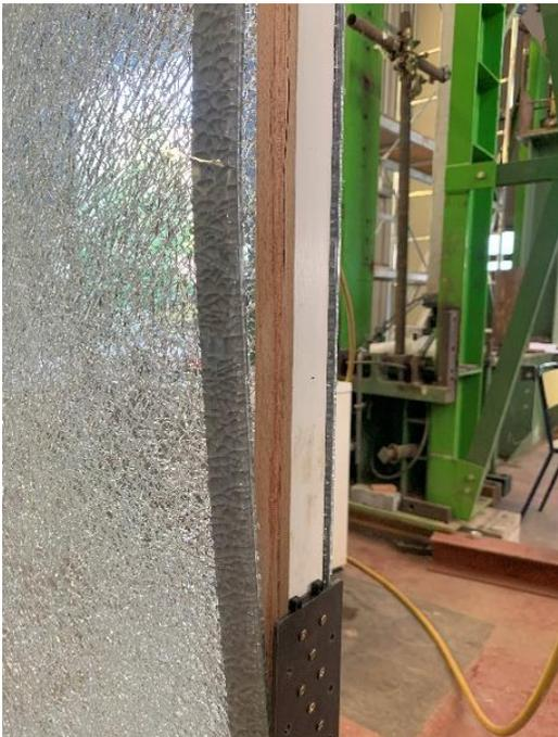
**Figura 57.** Dettaglio di scollaggio del vetro prova 5
