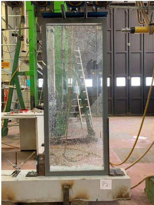
*Figura 45. Stato di collasso prova 2*
