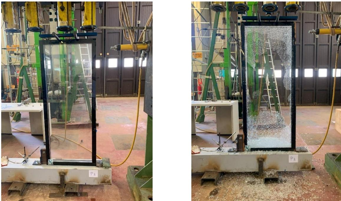
**Figura 25.** Prova sperimentale 3 pre e post rottura
