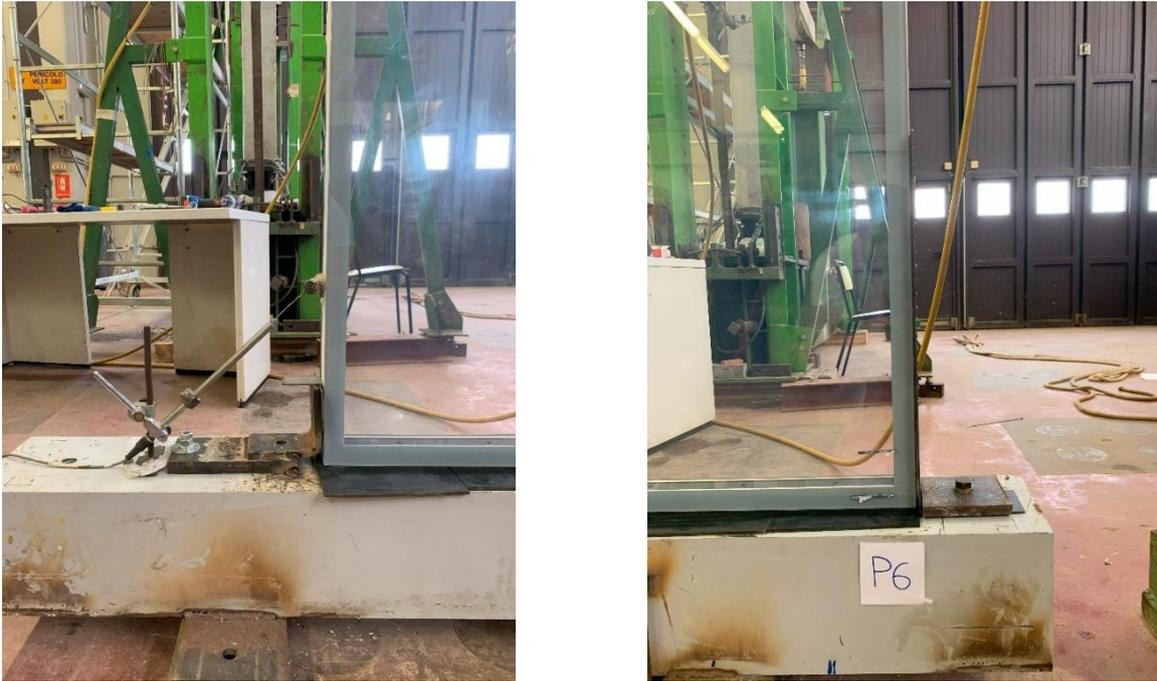
**Figura 17.** Elementi di fissaggio dei pannelli
