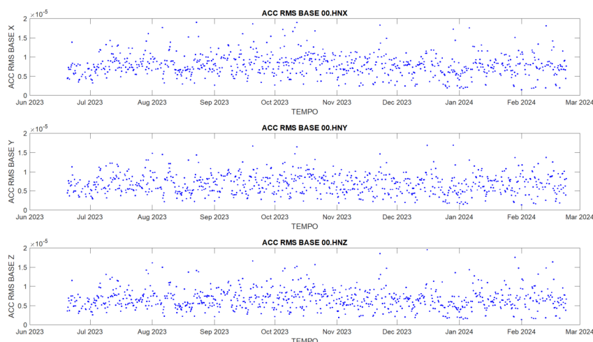
Figura 2-62: Monitoraggio Condominio Santarelli 2A – Andamento RMS accelerazione alla base-tempo
