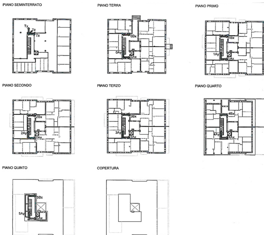
Figura 2-48: Disposizione dei sensori ai vari piani per la prova AVT su Condominio Spontini
