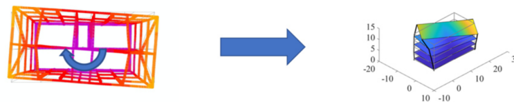
Figura 4-79: Confronto forme modali modelli numerici – dati sperimentali AVT (3°)
