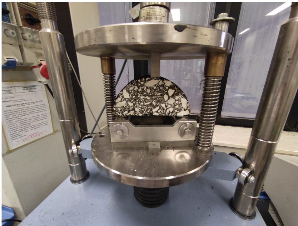
Figura 58 – Posizionamento provino prima dell'inizio prova a flessione semi-circolare
