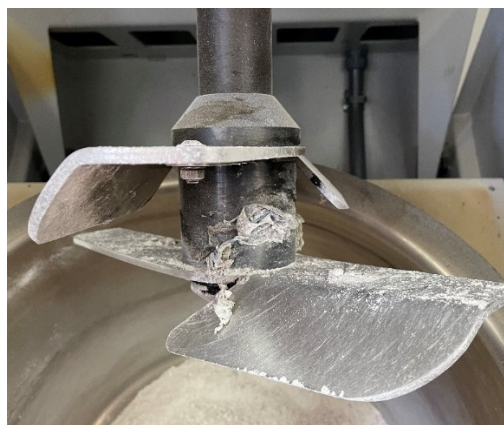
Fig. 65 – Cartocci di plastiche rimasti attaccati alla pala del miscelatore
