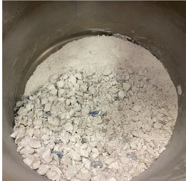
Fig. 66– Cartocci di plastiche presenti dopo la miscelazione con gli aggregati a 190°C
