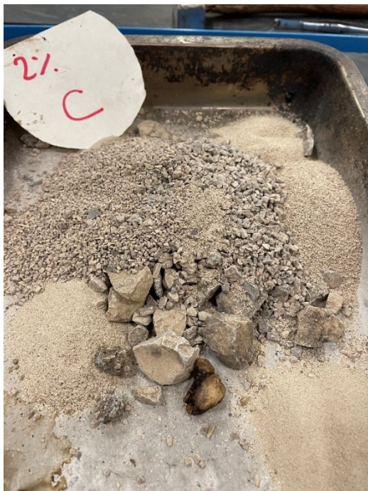
Fig. 88 – Aggregati estratti dalla miscela con 2% di plastiche tipo C
