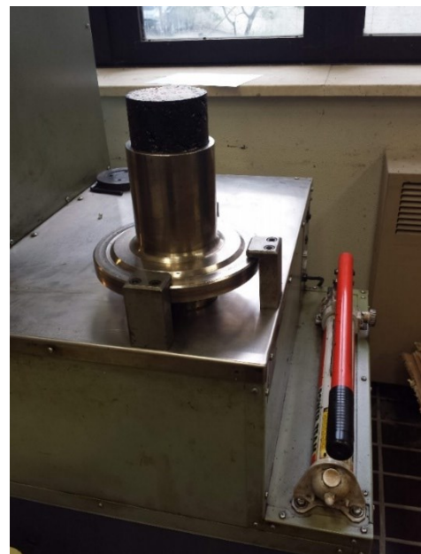
Figura 37: Operazione di rimozione del provino dalla fustella mediante martinetto idraulico
