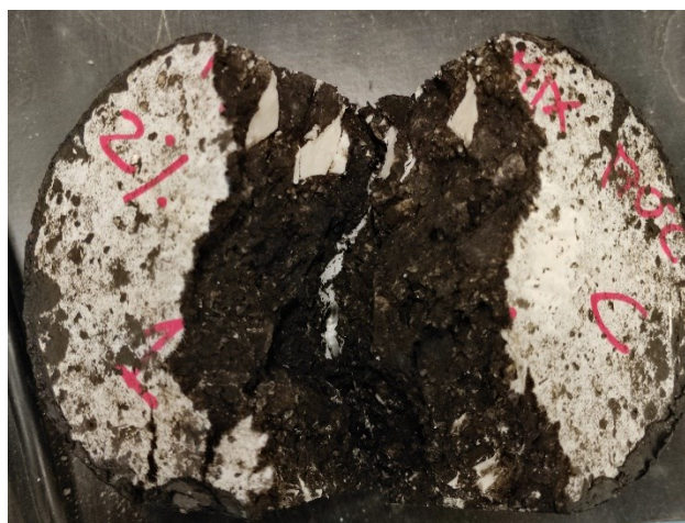
Figura 55 - Provino rotto a seguito della prova a trazione indiretta
