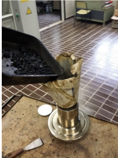
Figura 34: Materiale versato all'interno della fustella mediante imbuto
