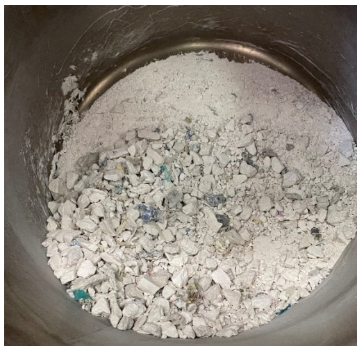
Fig. 64 – Cartocci di plastiche presenti dopo la miscelazione con gli aggregati a 170°C
