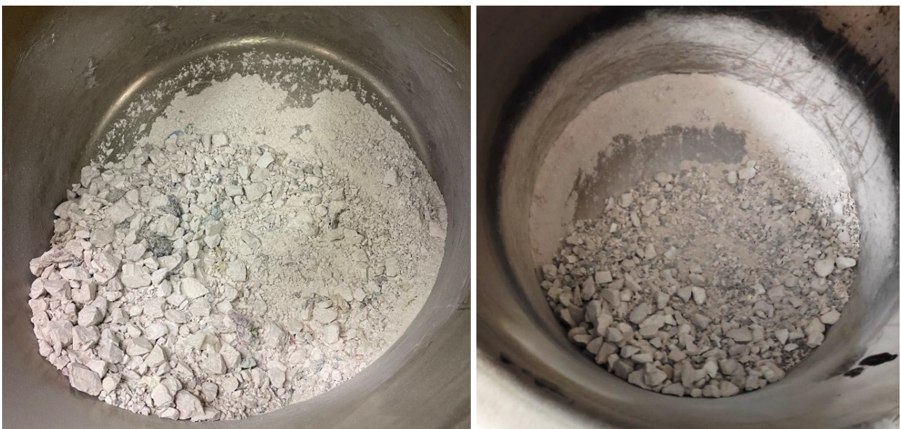
Fig. 67 – Grumi di plastiche estruse a sinistra e densificate a destra, presenti dopo la miscelazione con gli aggregati a 170°C
