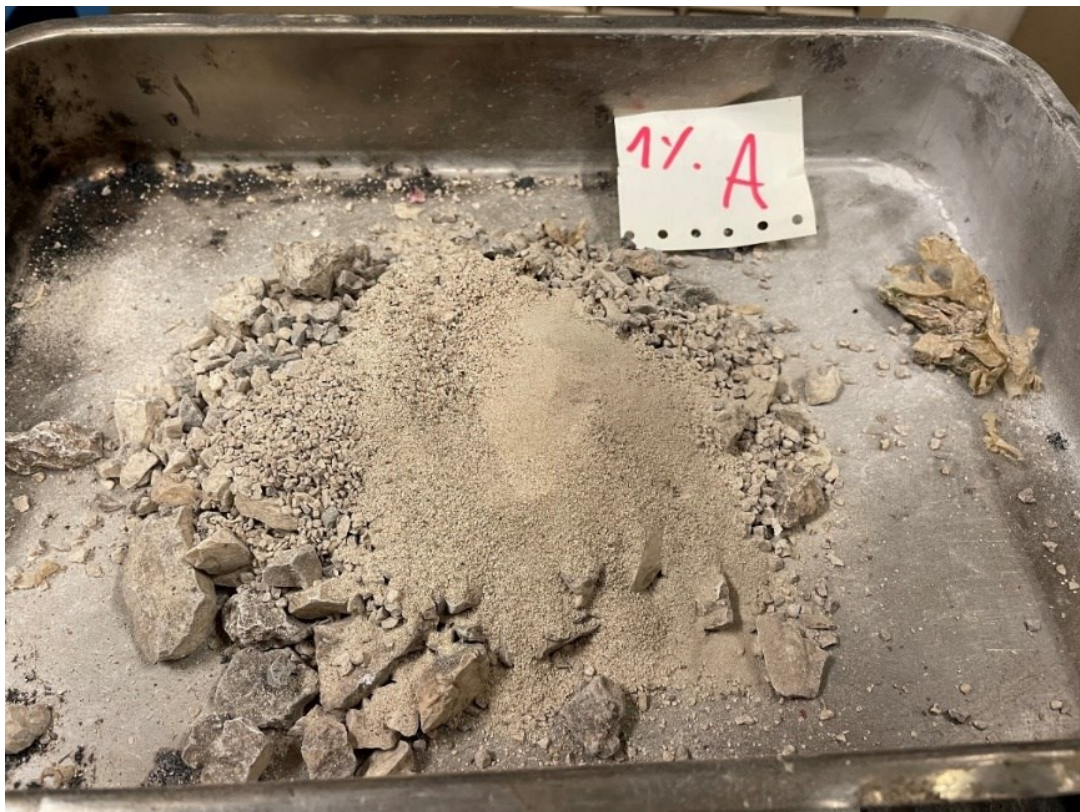
Fig. 84 – Aggregati estratti dalla miscela con 1% di plastiche tipo A
