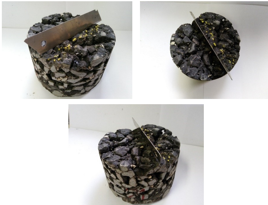
Figura 2.18: utilizzo di una lama per l'individuazione di un'eventuale cricca sulla superficie del provino
