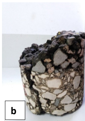
Figura 3.9: fotogramma ARAN nel quale è ben visibile la fessura superficiale (a), campione prelevato in sito in cui è visibile la cricca da top-down che si propaga in profondità (b-c)
