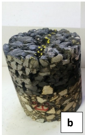
Figura 3.8: fotogramma ARAN nel quale è ben visibile la fessura superficiale (a), campione prelevato in sito in cui non è visibile nessuna cricca che si propaga in profondità (b-c)
