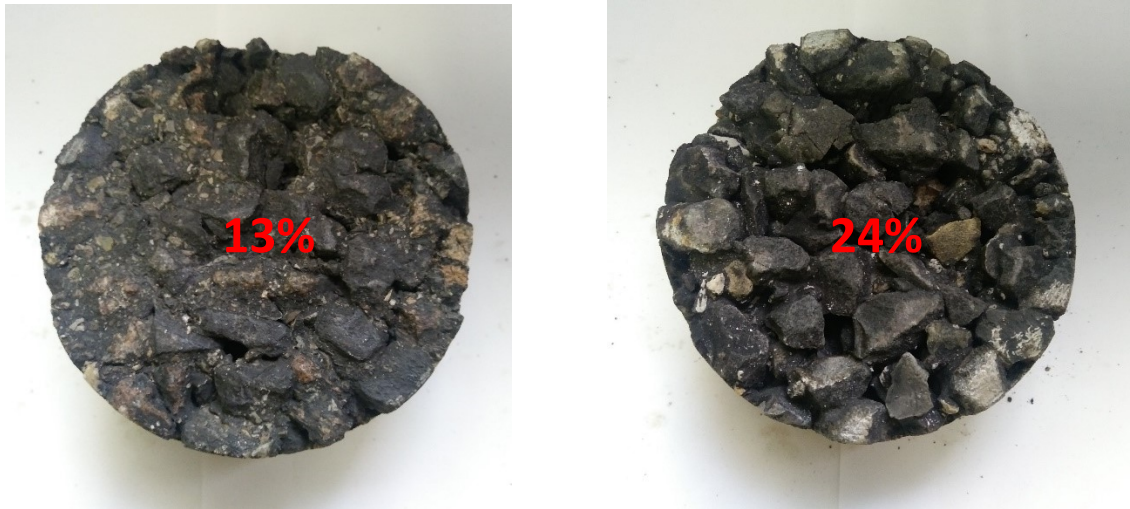
Figura 3.18: provini di drenante caratterizzati da percentuale dei vuoti molto differente
