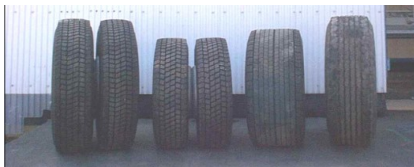
Figura 1.10: diverse tipologie di pneumatici (in particolare, da sinistra 315/80R22.5 gemellata, 295/65R22.5 gemellata, 495/45R22.5, 385/65R22.59)
