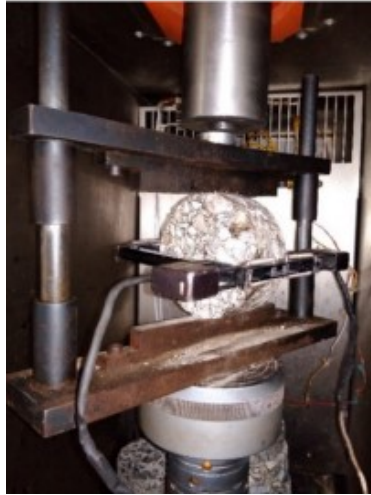
Figura 1.51: apparecchiatura utilizzata per la determinazione dell'energy ratio (ER)
