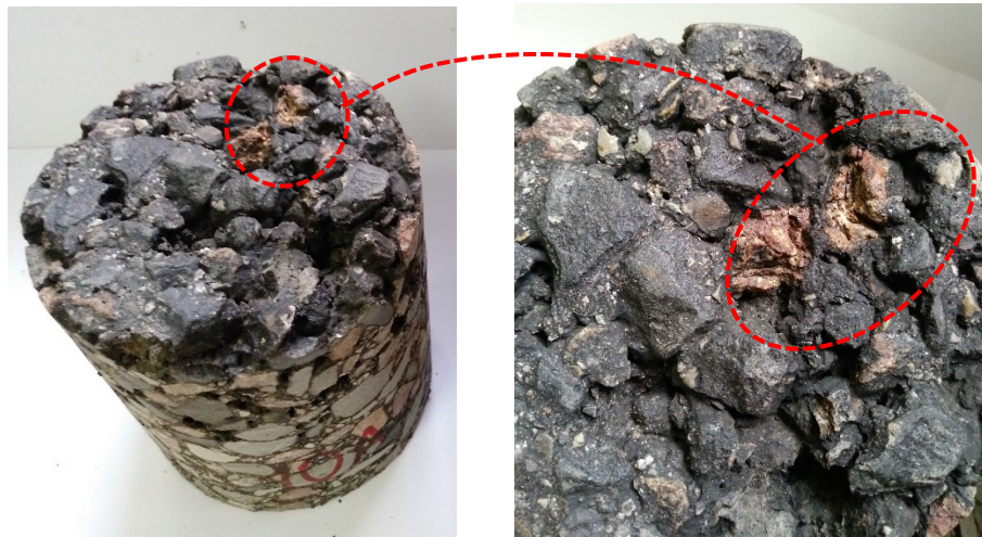
Figura 3.11: aggregato scheggiato dal passaggio del cerchione a seguito della foratura
