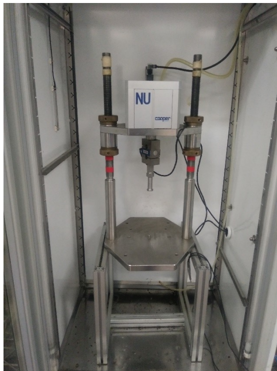
Figura 2.21: apparato generale dell'apparecchiatura NAT
