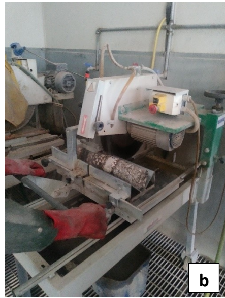
Figura 2.16: operazioni preliminari dell'analisi sperimentale: carote arrivate in laboratorio (a); taglio dei provini (b)
