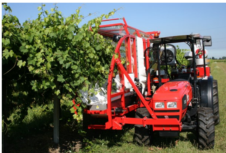
Figura 4: vendemmiatrice a scuotimento verticale portata lateralmente
