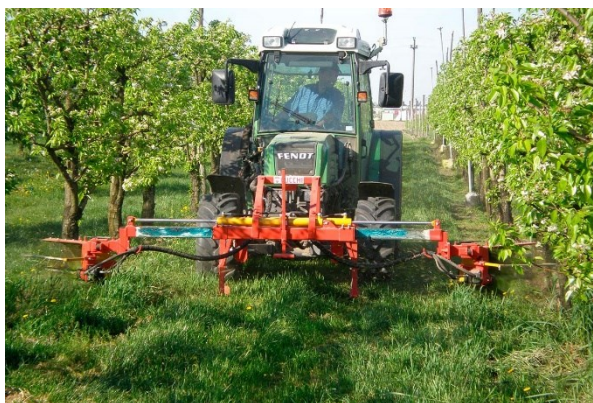
Figura 20: spollonatrice ad asse orizzontale bilaterale
