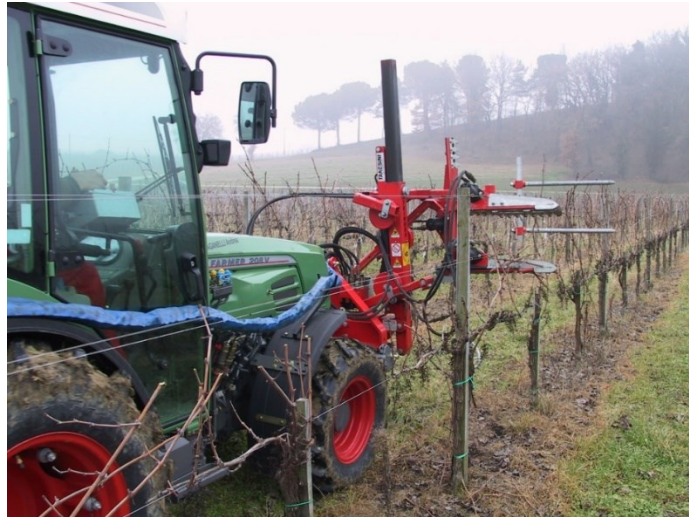
Figura 7: potatrice a barra portata anteriormente
