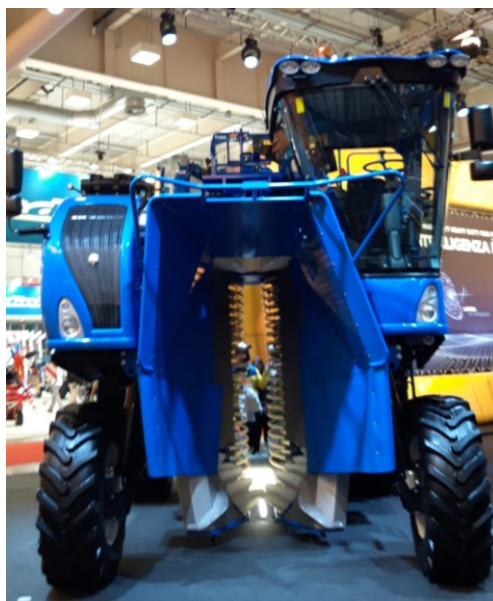
Figura 5: tunnel di raccolta vendemmiatrice a scuotimento orizzontale
