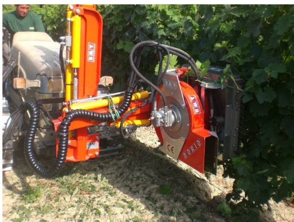
Figura 16: defogliatrici ad aspirazione ed apparato di taglio alternativo
