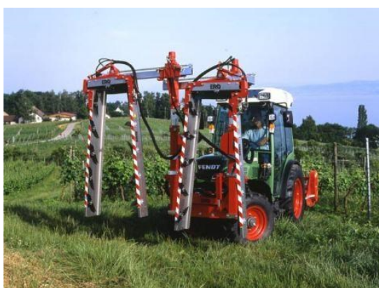
Figura 12: cimatrici a coltelli con struttura a doppia U rovesciata
