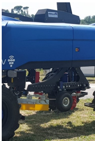
Figura 40: dettaglio sul telaio porta attrezzi con disco per lavorazione sottofilare
