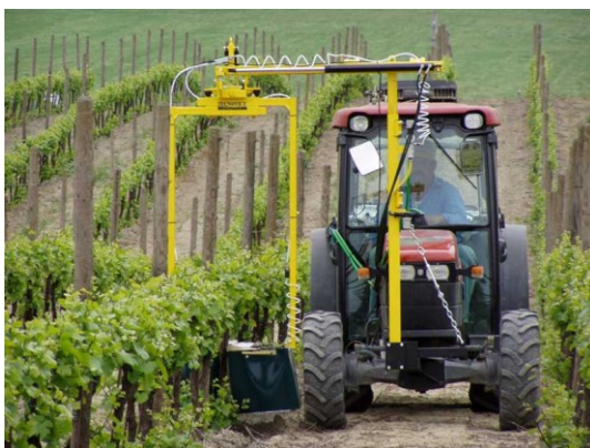
Figura 22: spollonatrice chimica Tecnovit
