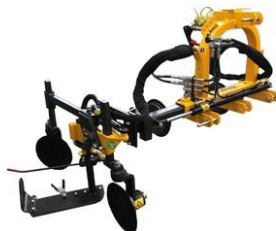
Figura 34: coltello abbinato ad erpici a dischi
