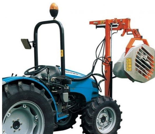
Figura 15: defogliatrice ad aspirazione ed apparato di taglio rotante
