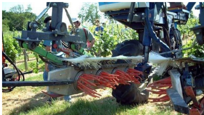
Figura 21: spollonatrice ad asse trasversale
