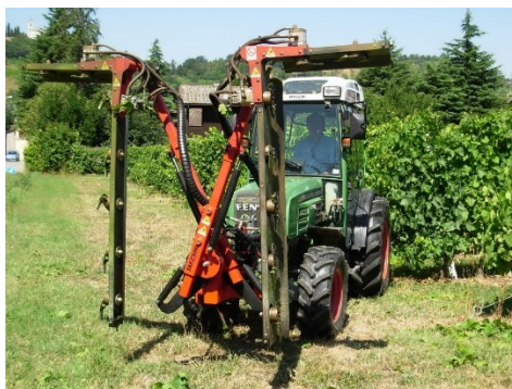
Figura 11: cimatrici a coltelli rotanti con struttura a doppia L rovesciata
