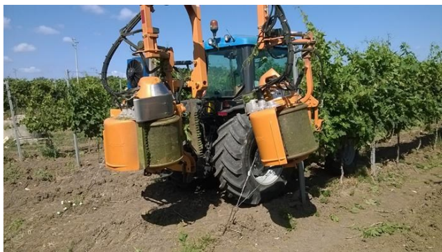
Figura 18: defogliatrice ad aspirazione a tamburi rotanti flessibili
