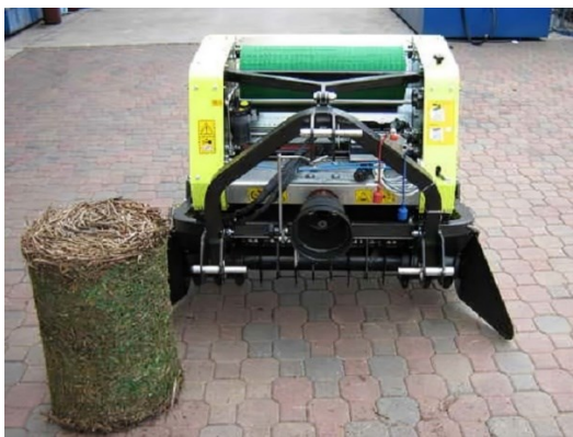
Figura 10: imballatrice per vigneto con “balletta” di residui di potatura
