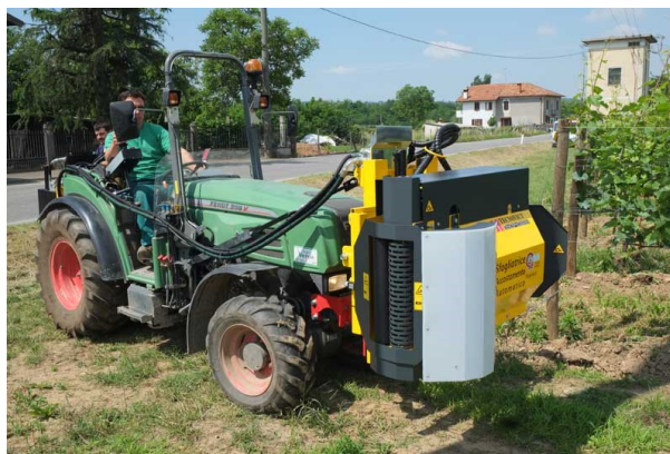
Figura 17: defogliatrice ad aspirazione e strappo con tecnologia di accostamento automatico alla vegetazione
