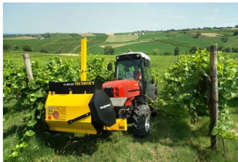
Figura 38: sfogliatrice TECNOVIT con sensori per la determinazione della parete vegetativa
