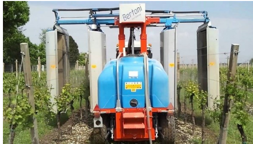
Figura 24: atomizzatore bifilare a recupero Bertoni
