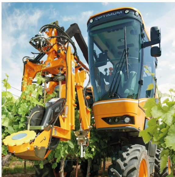
Figura 19: palizzatrice multi-attrezzo Pellenc
