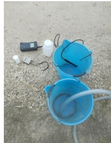
Figura 37, Conducimetro usato durante la prova
