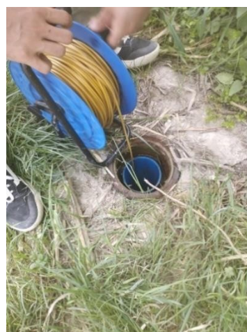
Figura 34, Freatimetro nel piezometro esterno Betelico (a valle)
