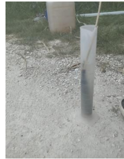
Figura 45, Log in 1 l di acqua+3 g di NaCl
