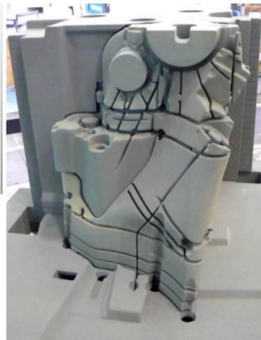
Fig. 10 Assemblaggio di anima e stampo fabbricati da 3DP
