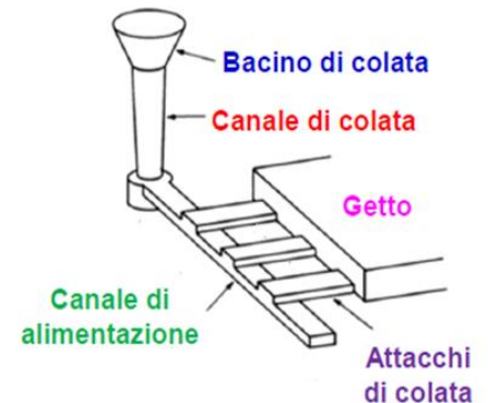
Fig.2 Sistema di colata
