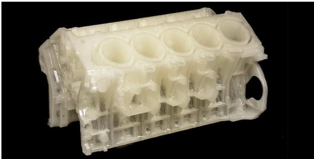
Fig.6 Blocco motore realizzato in PLA
