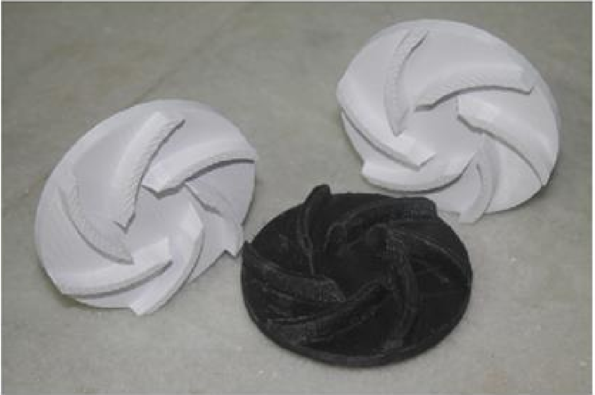
Fig. 13 Modello reale girante e modelli in ABS.
