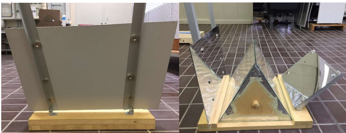
Fig. 56 – Posizionamento degli specchi, ultimazione del forno
