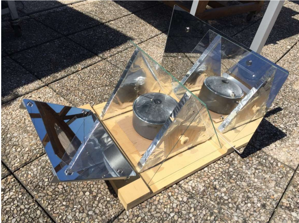
Fig. 83 – Forno durante la prova con carico
