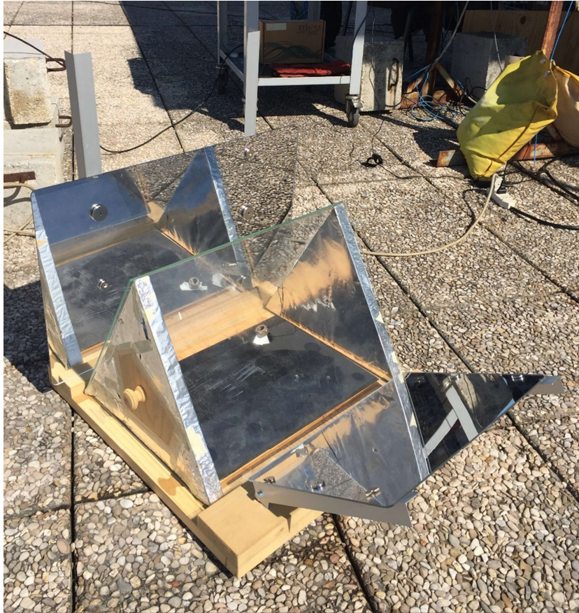
Fig. 79 – Forno durante la prova a vuoto con piastra
