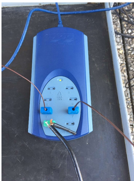
Fig. 70 – Collegamento delle termocoppie all'acquisitore
