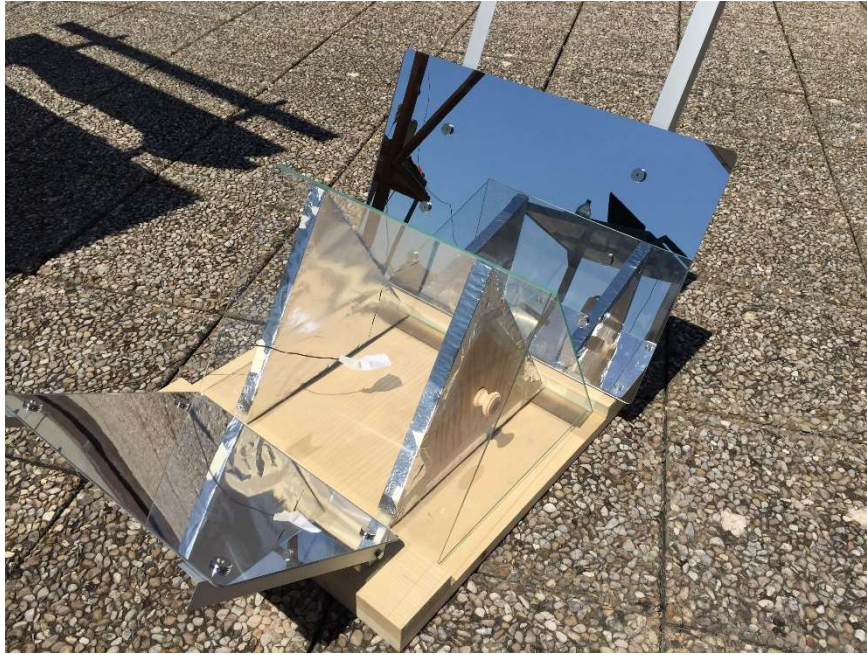
Fig. 75 – Forno durante la prova a vuoto senza piastra
