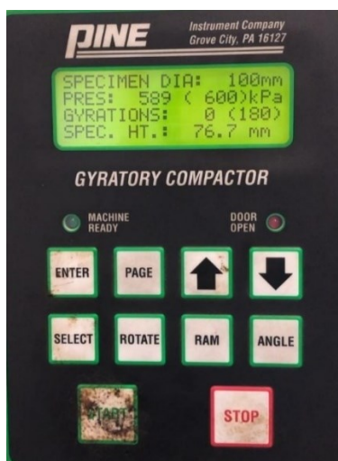
Figura 3.33: Schermo del pannello di controllo della pressa a taglio giratoria
