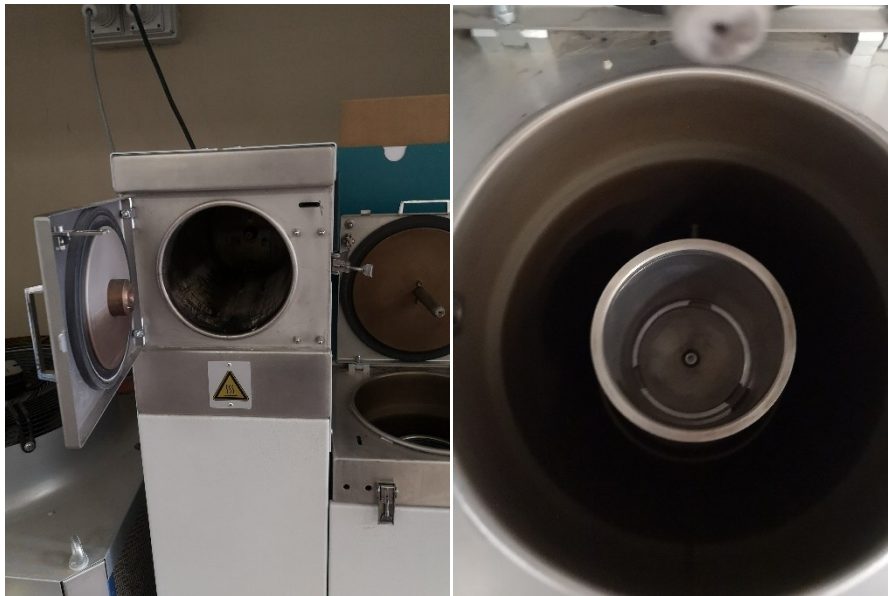
Figura 3.82: camera di lavaggio e centrifuga.
