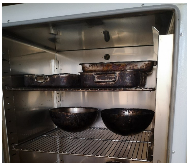
Figura 3.25: Porzioni di conglomerato reinserite nel forno
