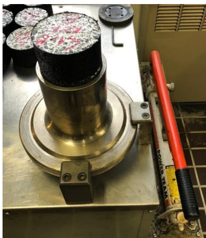
Figura 3.34: Estrazione provino mediante martinetto idraulico
