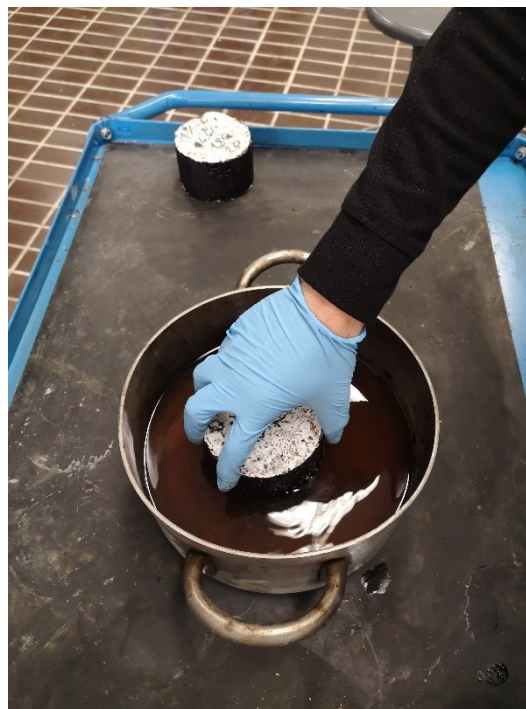
Figura 3.41: Rivestimento provino con paraffina allo stato liquido.
