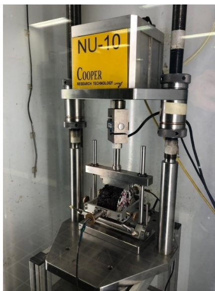
Figura 3.52: Cella di carico del NAT con al di sotto il castelletto contenente il provino
