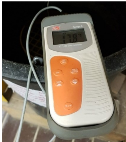
Figura 3.43: Controllo temperatura acqua.
