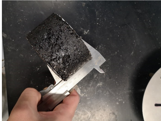
Figura 3.56: Misurazione altezza provini mediante calibro
