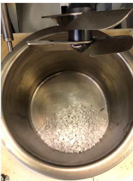
Figure 3.19- Aggregati immessi nell'impastatrice
