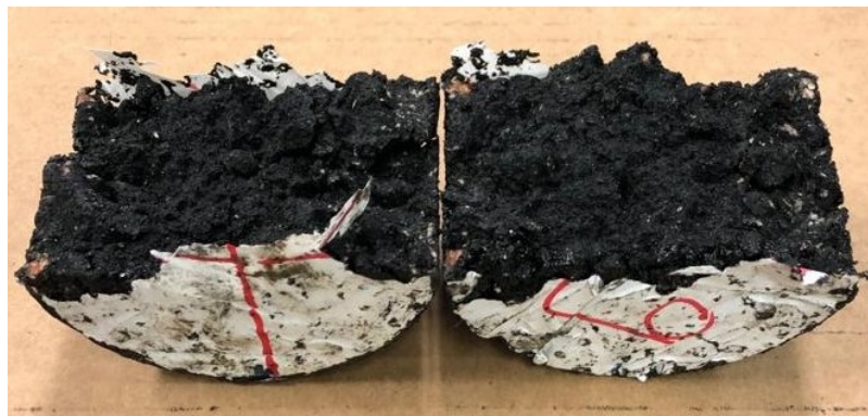
Figura 3.78: Provino al raggiungimento del punto di rottura.
