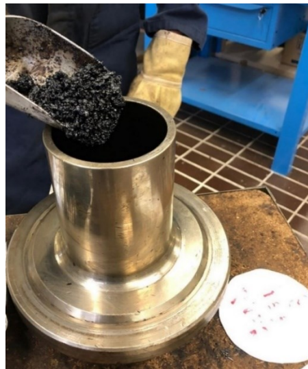
Figura 3.31: Riempimento fustella con conglomerato bituminoso
