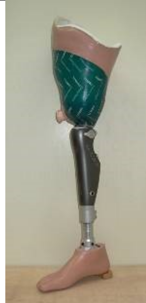
FIGURA 70: PROTESI CON GINOCCHIO ELETTRONICO REATTIVO CON TECNOLOGIA IDRAULICA 29
