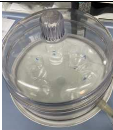
Figura 2.7. Pezzi immersi in acqua all'interno della cappa aspirante per saturare la porosità aperta con acqua.
