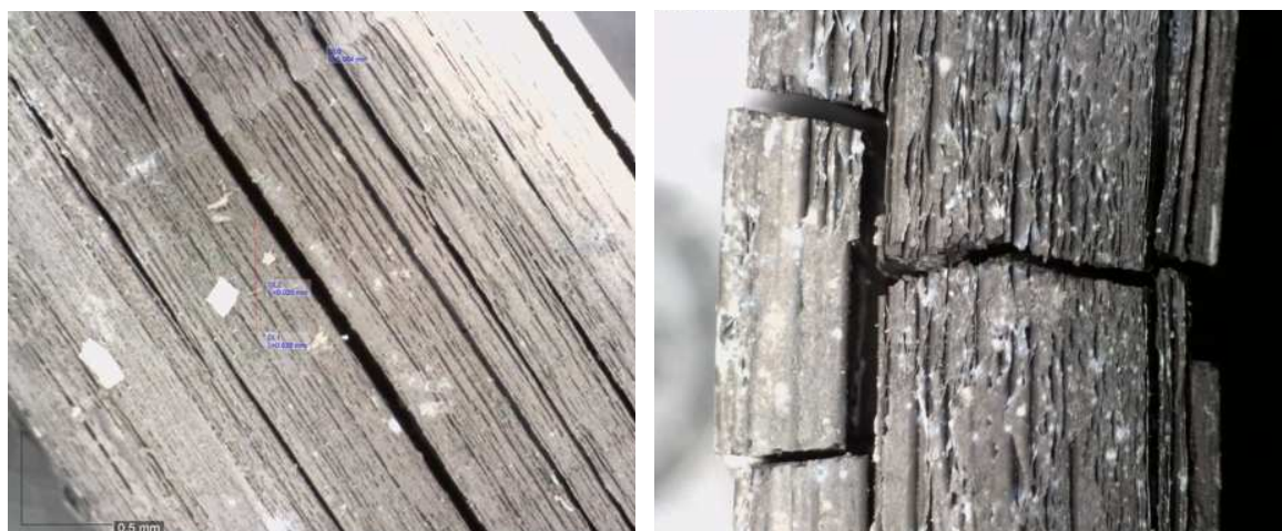
Figura 3.10. Micrografie ottiche della superficie laterale dei campioni dopo debinding in forno convenzionale.
