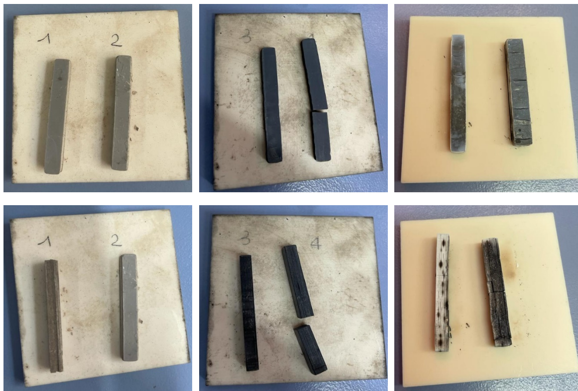
Figura 3.9. Immagini ottiche di parti numerate, ordinate da sinistra a destra, dopo il trattamento termico di debinding: vista dall'alto (dall'alto) e vista laterale (dal basso).
