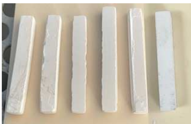
Figura 3.6. Da sinistra a destra: pezzi 1, 2, 3, 4, 5 e 6 utilizzati negli esperimenti. I piccoli difetti osservabili sono limitati ai primi strati stampati
