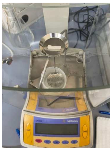
Figura 2.6. Bilancia analitica e misurazione del peso secco.
