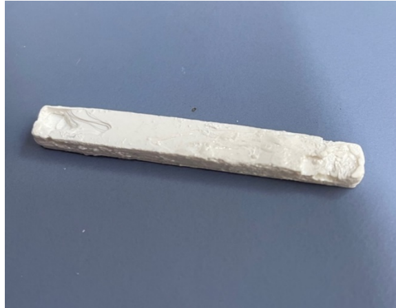
Figura 3.4. Parte difettosa stampata con un'altezza dello strato di 25 \mu\text{m} .
