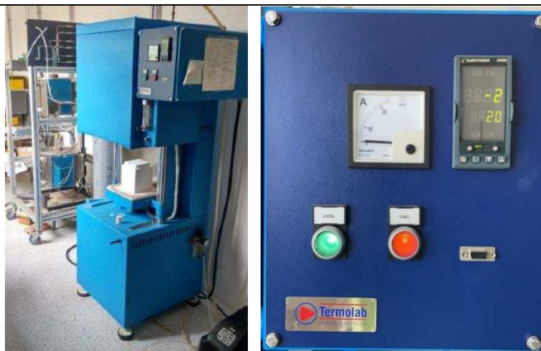
Figura 2.4. Forno elevatore convenzionale utilizzato per la sinterizzazione di pezzi ceramici e il trattamento di debinding in aria.
