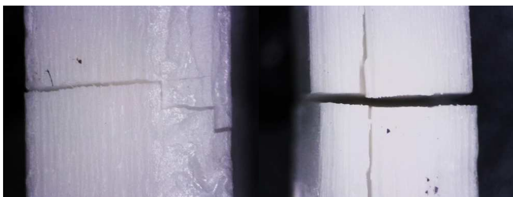
Figura 3.14. Micrografie ottiche della superficie laterale di campioni sinterizzati fratturati.
