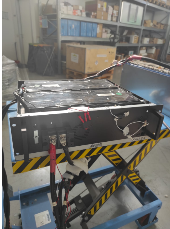
Figure 15: Pacco batterie da 16 celle in serie Midac
