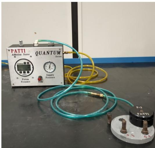
Figura 2.11 apparecchiatura per prova BBS
