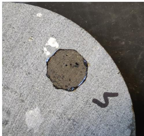
Figura 2.19 rottura adesiva
