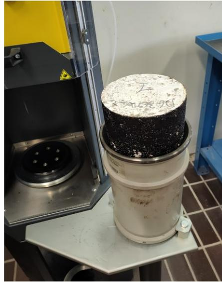
Figura 2.34 provino da pressa giratoria
