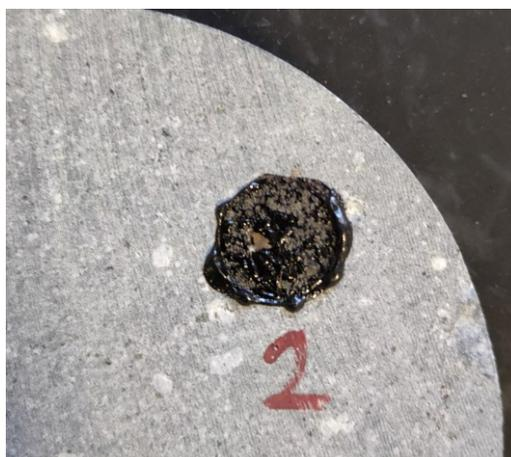
Figura 2.20 rottura ibrida
