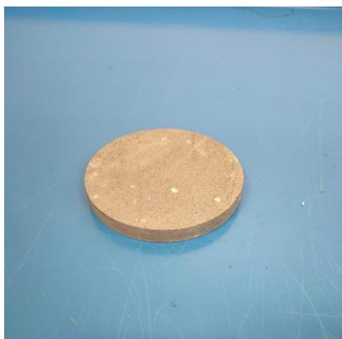
Figura 2.6 dischi in basalto per prova di adesione (BBS)
