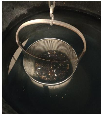
Figura 2.38 pesa idrostatica del campione
