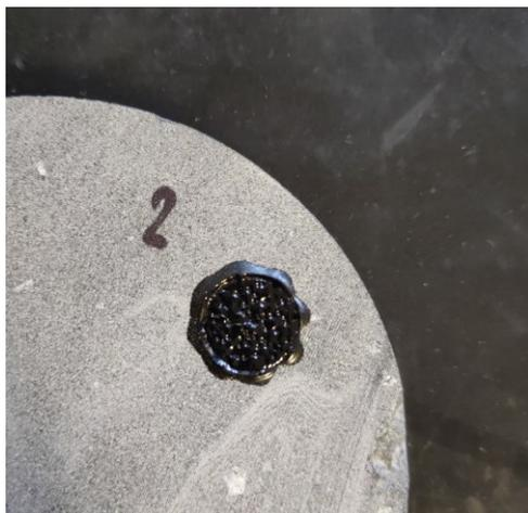
Figura 2.18 rottura coesiva
