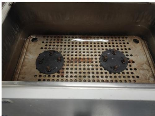
Figura 2.15 bagno termostatico
