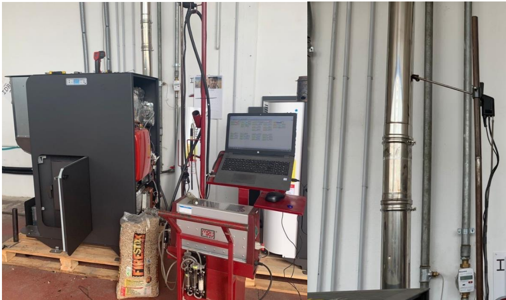
Figura 1.4: Nell'immagine di sinistra è presente la configurazione di set-up per l'esecuzione della prova, nell'immagine di destra si vede la sonda dei fumi inserita all'interno della canna fumaria.
