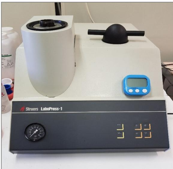
Figura 13: Inglobatrice per resine termoindurenti
