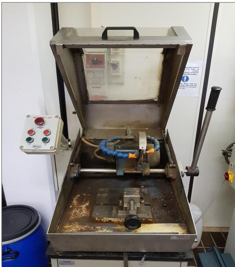
Figura 12: Macchina per il taglio con mola abrasiva
