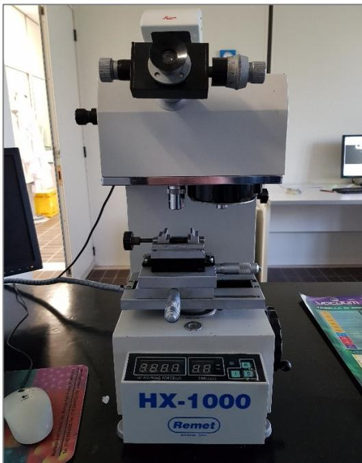
Figura 19: Microdurometro
