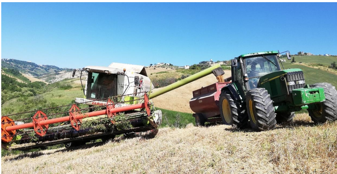
Figura 2-3: Fase di scarico
