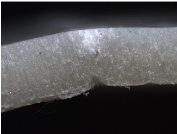
Figura 4.5. Rottura del provino ricavato dalla saldatura effettuata nelle condizioni di 1250-20-04, immagine acquisita allo stereomicroscopio con uno zoom di 20x
