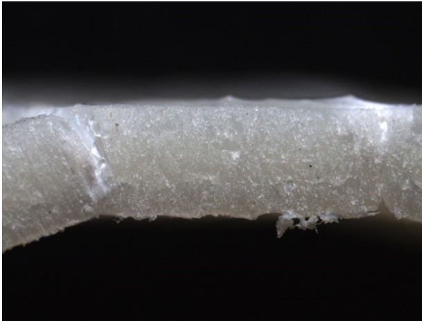
Figura 4.1. Immagine acquisita allo stereomicroscopio del provino ricavato dalla saldatura nelle condizioni di 800-40-04 con lo zoom di 16x
