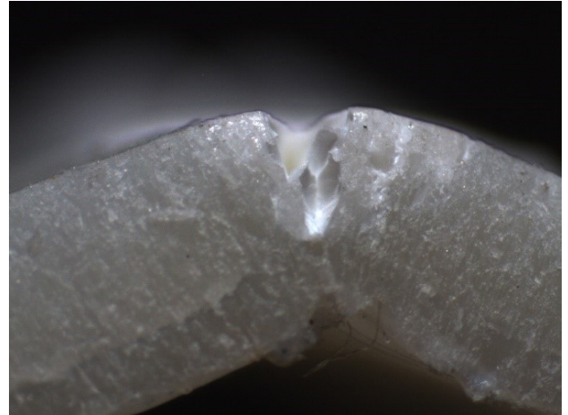
Figura 4.2. Immagine acquisita allo stereomicroscopio del provino ricavato dalla saldatura nelle condizioni di 1250-40-04 con lo zoom di 25x
