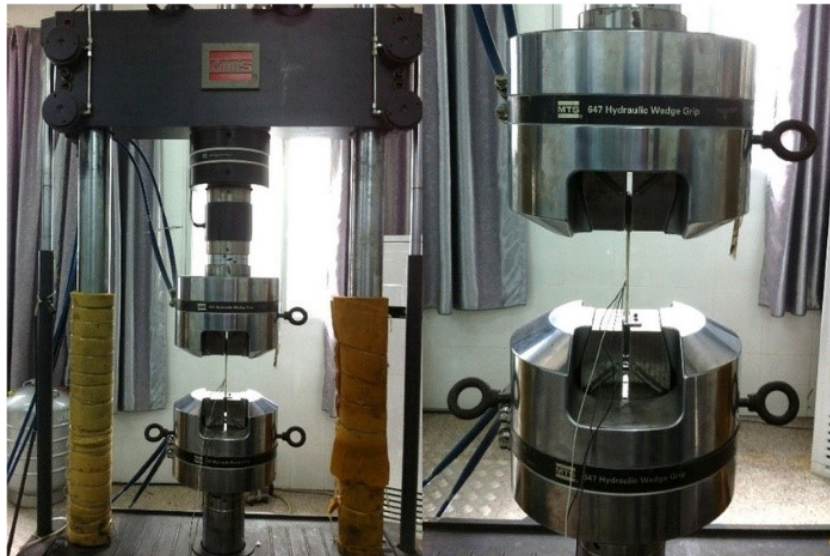
Figura 3.6. Rappresentazione della macchina MTS 810 utilizzata per la verifica dei provini a trazione
