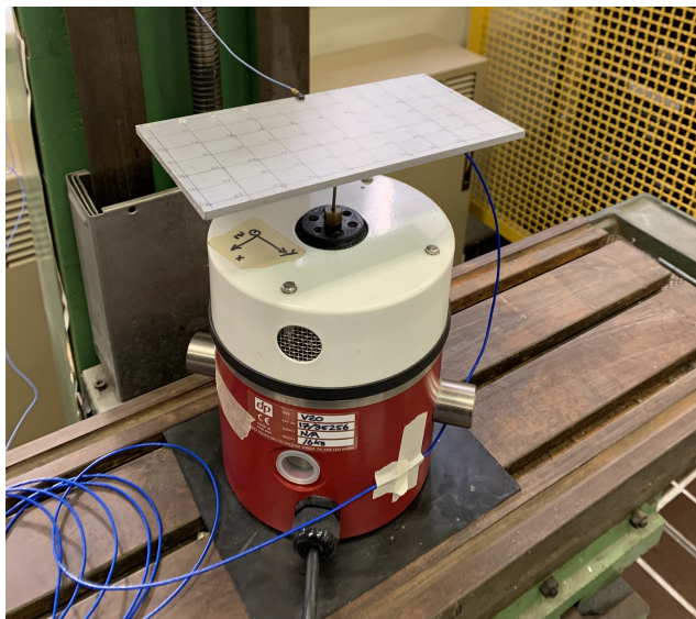
Figura 3.3: Set up per misure con accelerometro senza sonda
