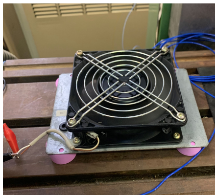
Figura 5.1: Ventola usata per misure di vibrazione
