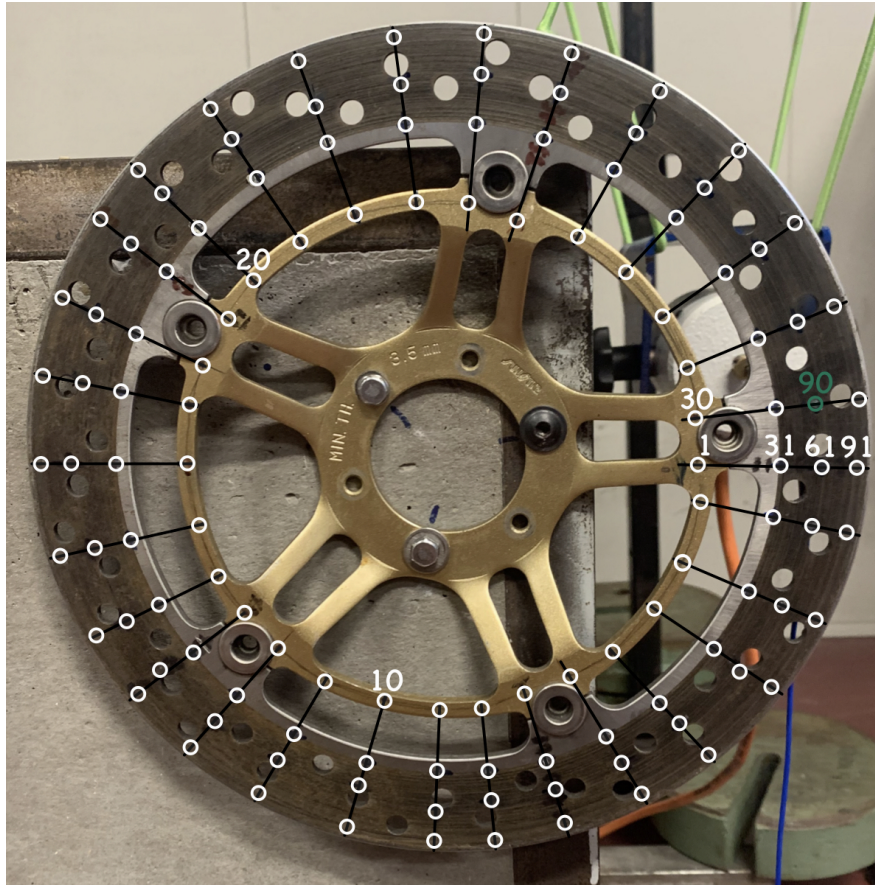
Figura 4.1: Disco freno usato per misure di vibrazione
