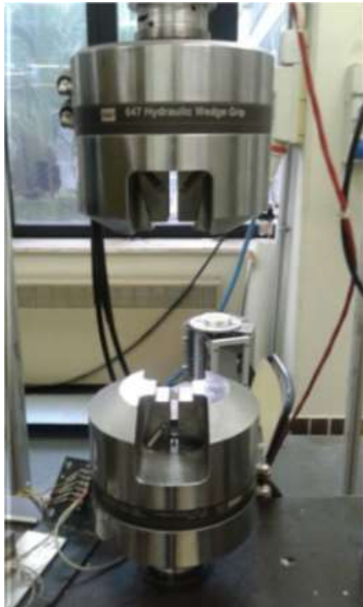
Figura 35:macchina di prova universale MTS
