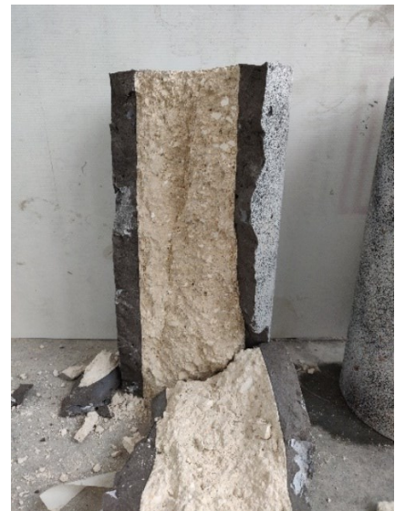
Figura 39 - Pilastro rinforzato con M-1.0 rCF dopo la prova a compressione.
