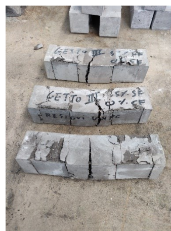
Figura 34 - Provini realizzati con miscela M-1.5 SF rotti a compressione.
