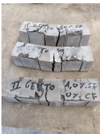
Figura 33 - Provini realizzati con miscela M-1.0 SF rotti a compressione.
