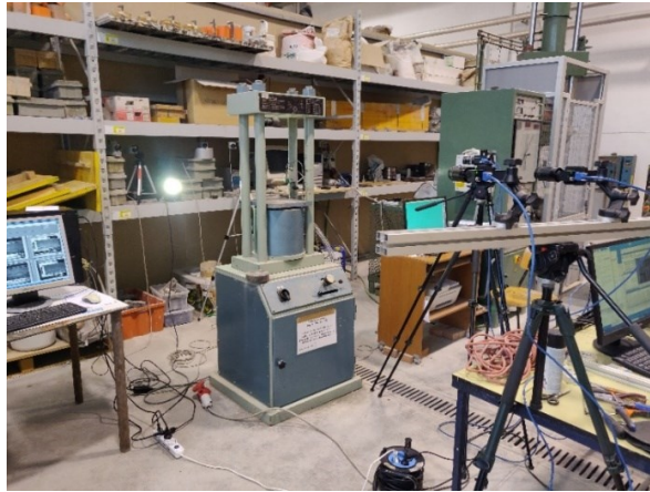
Figura 16 - Setup della prova a compressione dei pilastri rinforzati: pressa (al centro) e le 8 telecamere collegate a due PC e posizionate a diverse angolature, in modo tale da riprendere quasi tutta la superficie dei pilastri.
