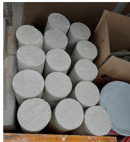
Figura 9 - Aspetto dei provini dopo lo scassero.
