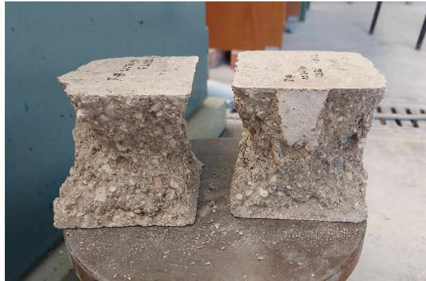
Figura 10 - Provini rotti dopo la prova a compressione.
