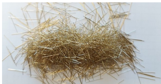
Figura 6 - Fibre in acciaio utilizzate per le miscele.
