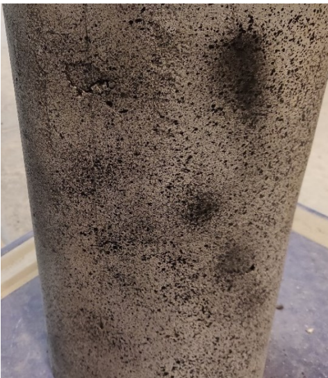
Figura 17 - Particolare della verniciatura "a macchie" della superficie di uno dei pilastri rinforzati, utile al sistema DIC per il riconoscimento di punti.
