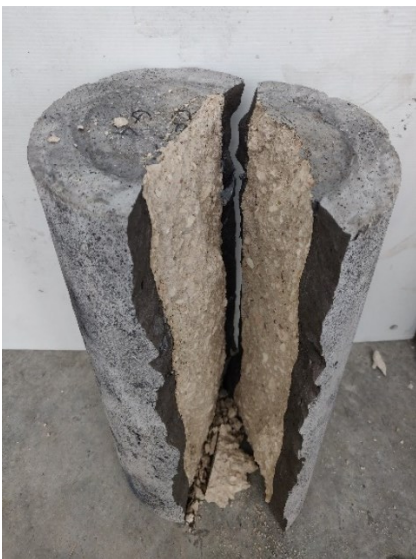
Figura 38 - Pilastro rinforzato con M-1.0 rCF dopo la prova a compressione.
