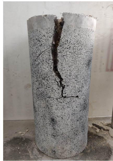
Figura 43 - Pilastro rinforzato con M-1.5 SF dopo la prova a compressione.
