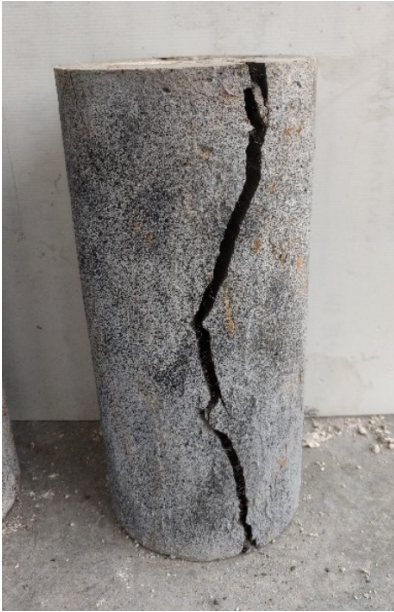
Figura 40 - Pilastro rinforzato con M-1.0 SF 0.5 rCF dopo la prova a compressione.
