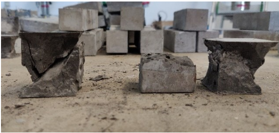
Figura 35 - Provini realizzati con miscela M-1.0 rCF rotti a compressione.
