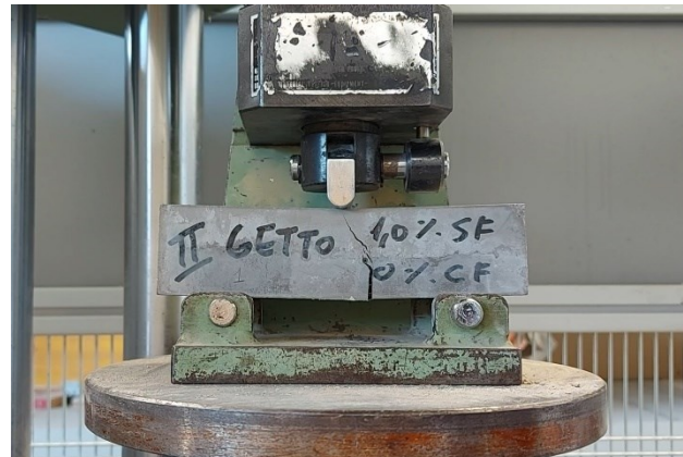
Figura 14 - Setup della prova a flessione a tre punti, rottura di un provino M-1.0 SF.
