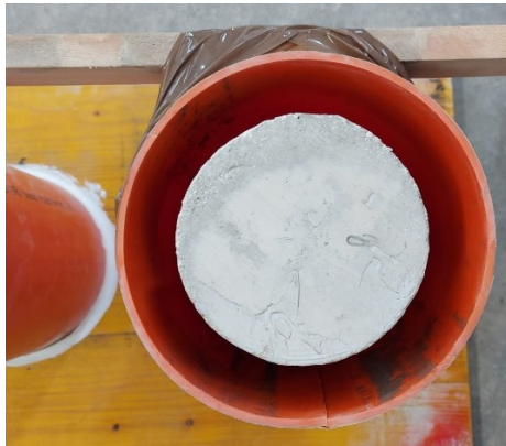
Figura 12 - Setup del getto destinato all'incamiciatura dei pilastri in calcestruzzo.
