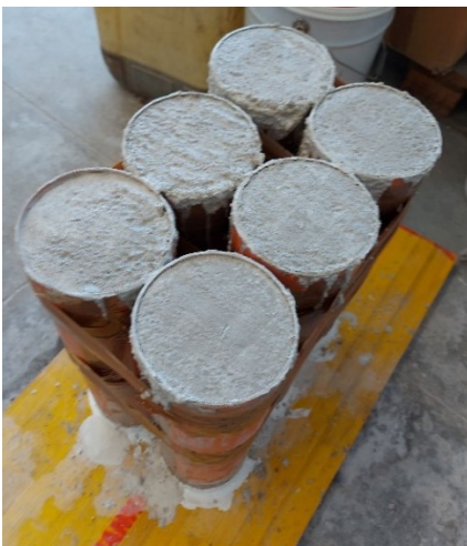
Figura 8 - Maturazione del getto nei casseri in PVC.
