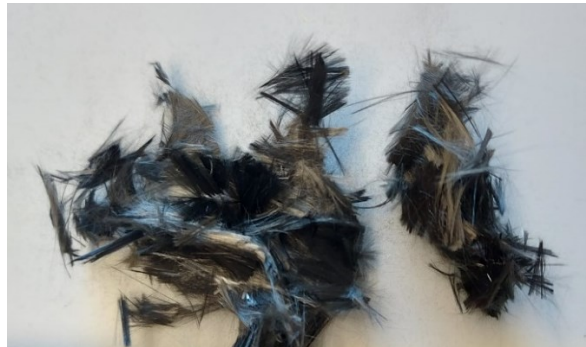
Figura 7 - Fibre di carbonio riciclate utilizzate per la sperimentazione.
