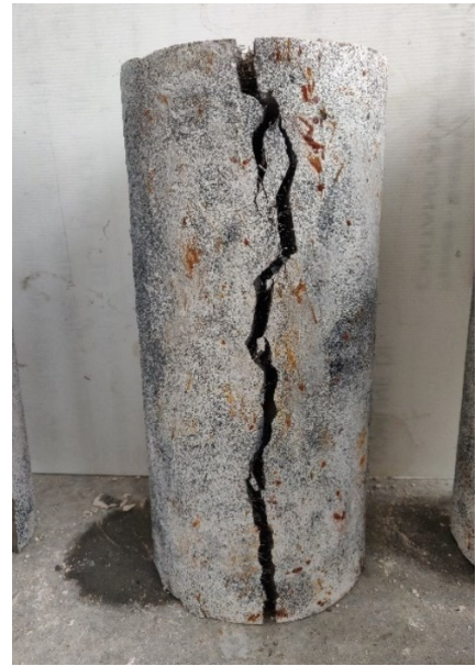
Figura 41 - Pilastro rinforzato con M-1.0 SF 0.5 rCF dopo la prova a compressione.
