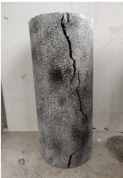
Figura 42 - Pilastro rinforzato con M-1.5 SF dopo la prova a compressione.
