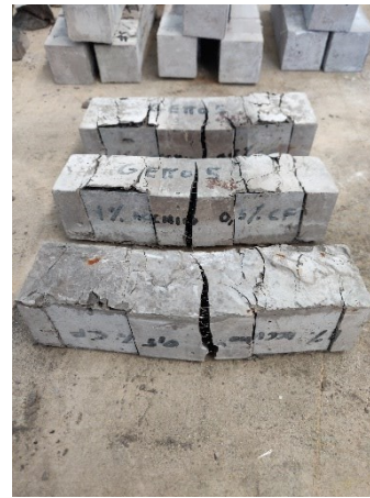
Figura 36 - Provini realizzati con miscela M-1.0 SF 0.5 rCF rotti a compressione.
