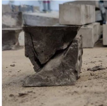
Figura 15 - Rottura a clessidra di un cubetto ottenuto da un provino realizzato con miscela M-1.0 rCF rotto precedentemente con la prova a flessione.
