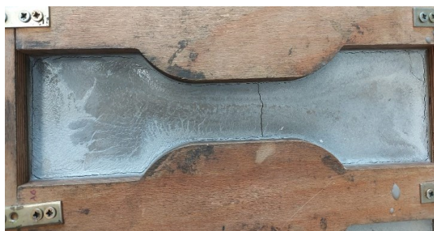
Figura 11 - Provino a "osso di cane" rotti prima dello scasso.
