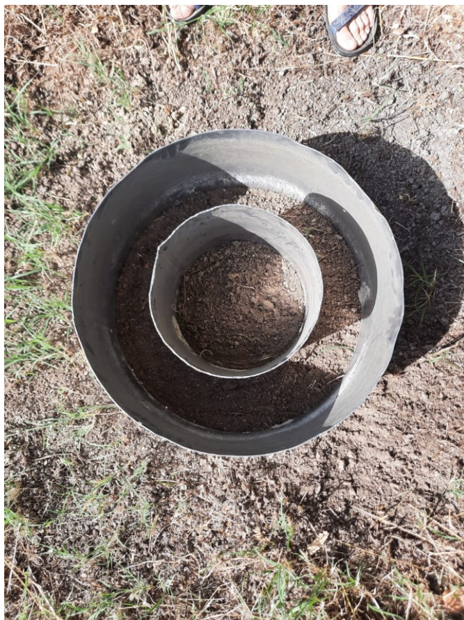
Fig. 4.21 Posizione degli anelli in acciaio per le prova infiltrometrica
