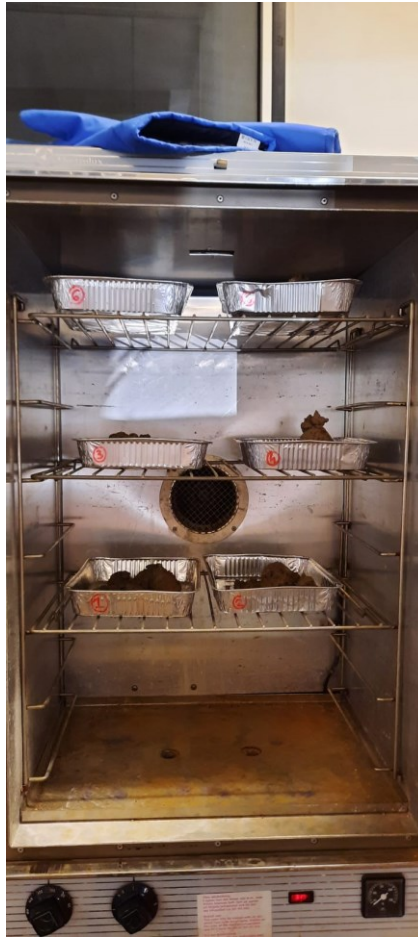
Fig. 4.36 Disposizione provini di terreno all'interno del forno da laboratorio
