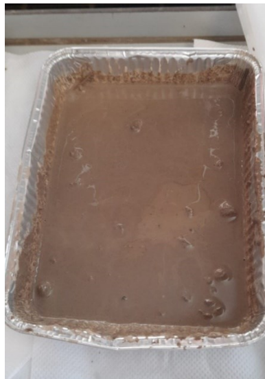
Fig. 4.37 Provino pronto per essere sottoposto all'analisi granulometrica
