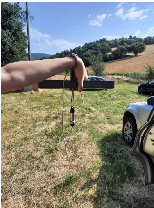
Fig. 4.23 Posizionamento trasduttore di pressione
