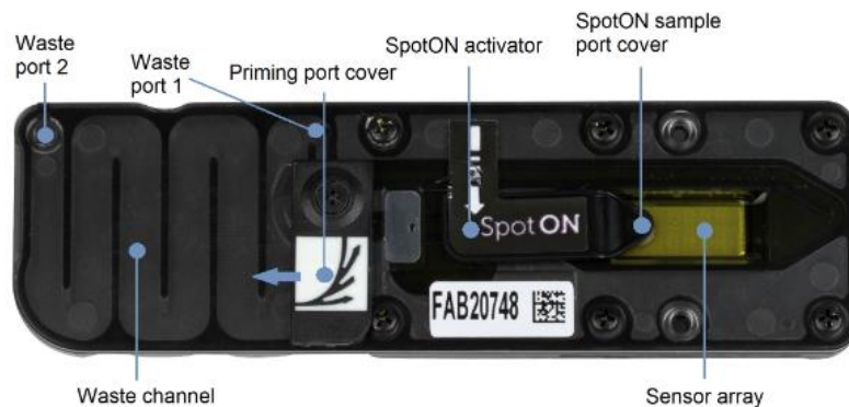
Figura 17. Struttura di una flow cell per MinION MK1b.
