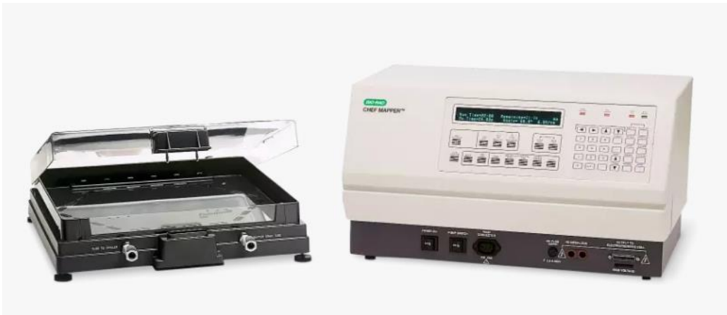
Figura 15. Apparecchiatura Chef Mapper XA System (Biorad) utilizzata per analisi PFGE.
