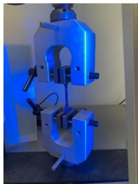
**Figura 21 Provino durante il test di trazione.**
