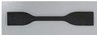
**Figura 17 Provino di trazione in PA12**
