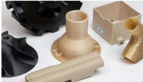
**Figura 6 Pezzi realizzati con Polimeri ad Alte Prestazioni.**
