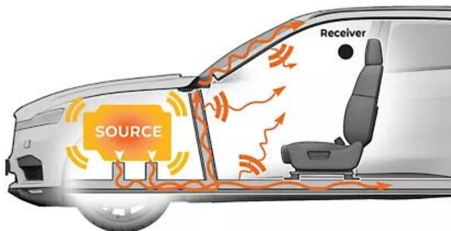
Figura 4. Esempio di sorgenti di vibrazioni e rumori in un veicolo
