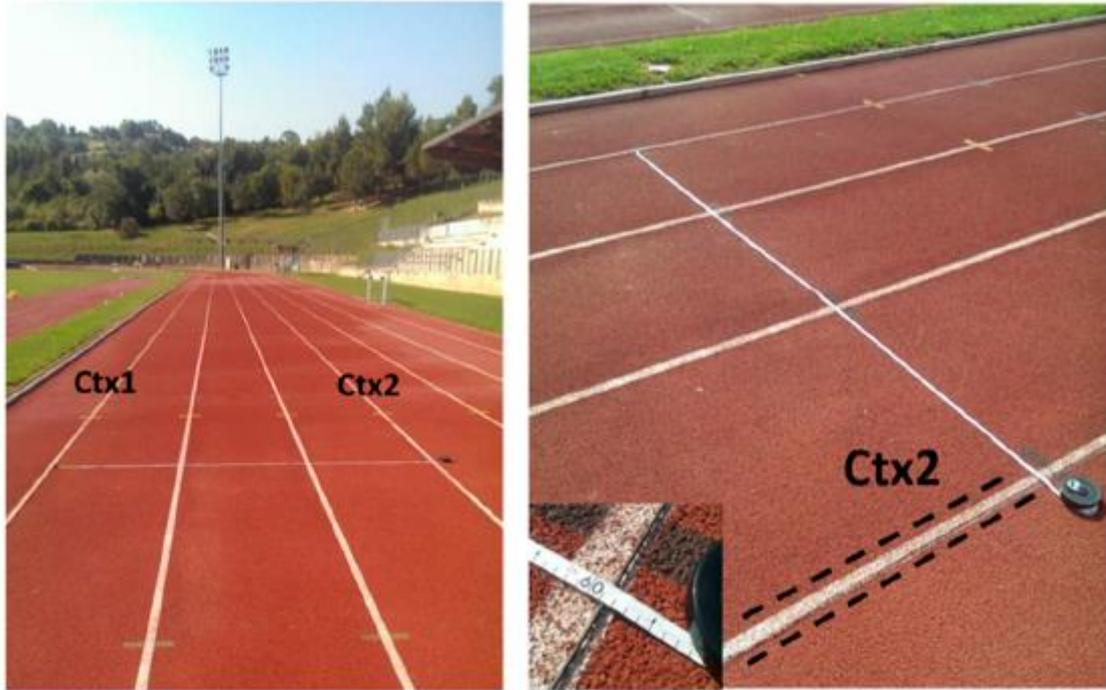
Figura 3: fotografia del loop creato sperimentalmente su pista.
