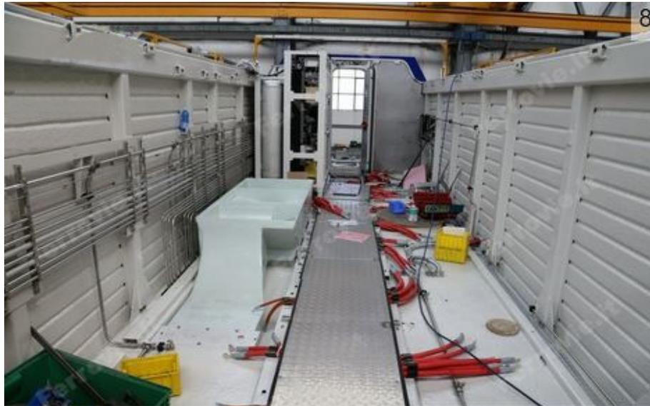
*Figura 2-8: Interno di una vettura in fase di allestimento*
