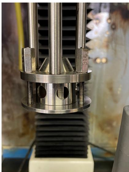
Figura 3.2.2 Particolare della girante adottata.
