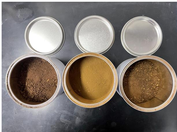
Figura 3.1.4 Da sinistra a destra, lignina B, M ed S una volta essiccate e macinate.
