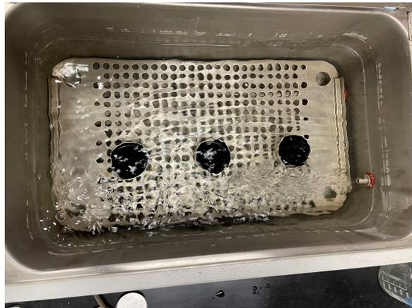
Figura 3.2.3 Bagno termostatico con all’interno i provini posti a essere condizionati.
