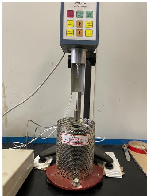
Figura 3.2.9 Viscosimetro con la spindle S21.
