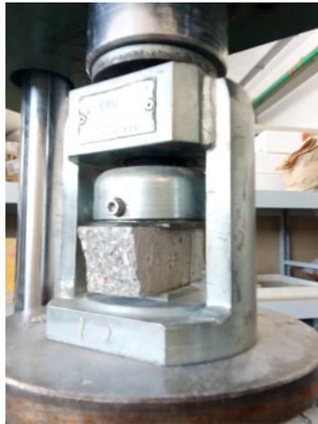
*Fig. 29* Supporto per prova di compressione
