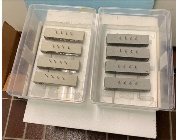
*Fig. 43 Malte immerse nella soluzione di NaCl*
