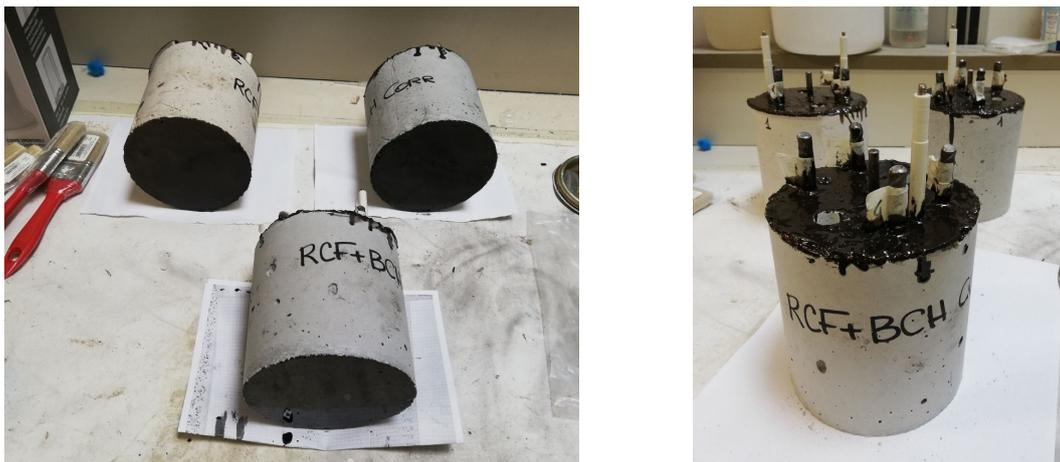
*Fig. 48* Provini dopo l'applicazione della resina epossidica
