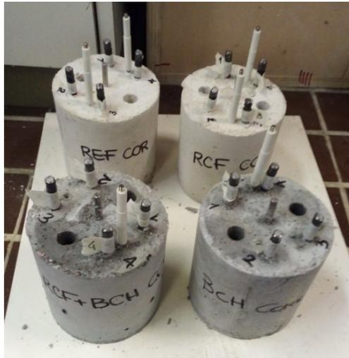
*Fig. 23* Provino dopo scassero prima della resinatura
