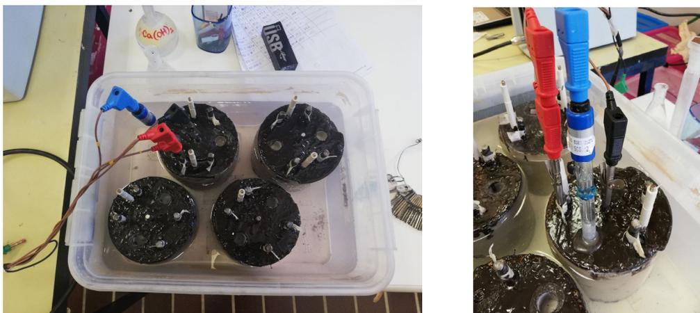
*Fig. 51 Esempio di prova di corrosione in bagnato*
