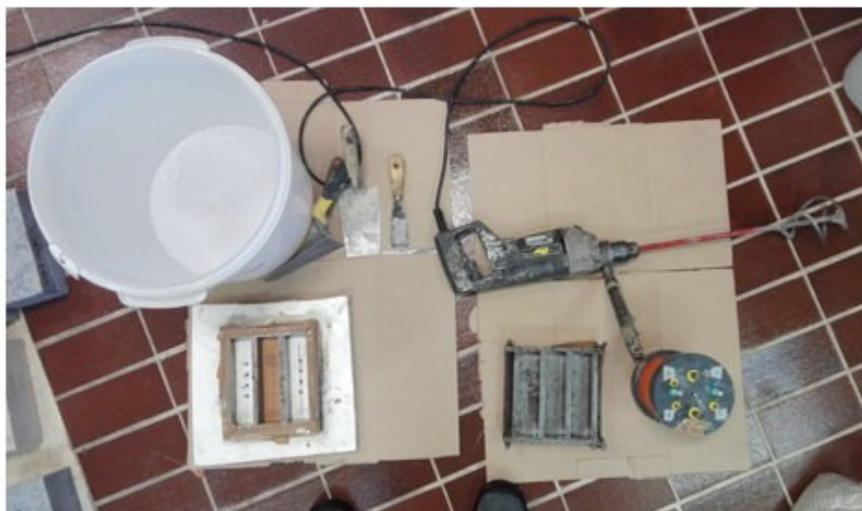
*Fig. 18* Trapano miscelatore e altri strumenti necessari per la tecnica di impasto.
