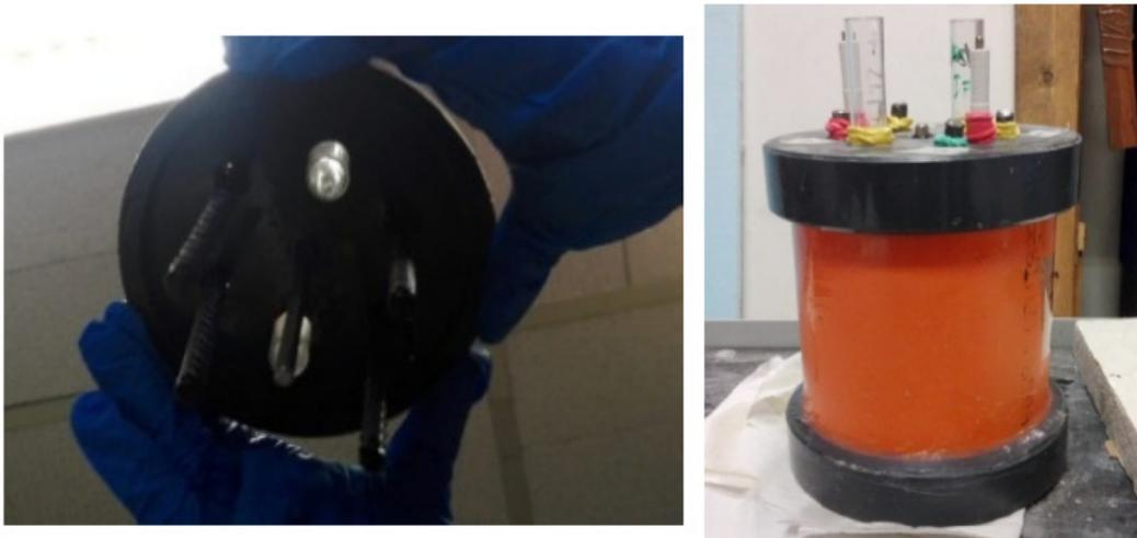
*Fig. 22 Coperchio superiore provini cilindrici per alloggiamento vari elementi*
