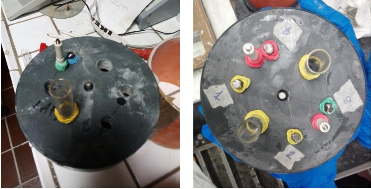
*Fig. 15* Assemblaggio delle barre di armatura, degli elettrodi di riferimento e dei controelettrodi al coperchio superiore del campione cilindrico.
