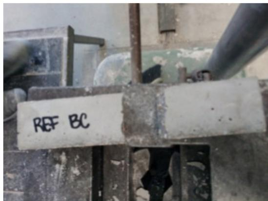
**Fig. 27** Rottura provino a fine prova
