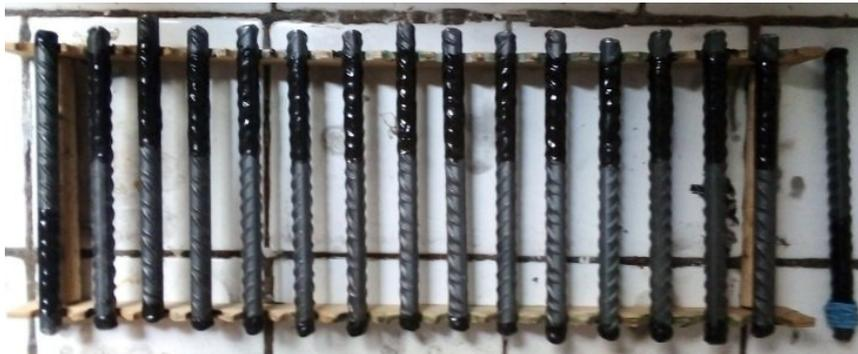
*Fig. 16* Barre di armatura ( $\text{Ø} = 8 \text{ mm}$ ) resinare.
