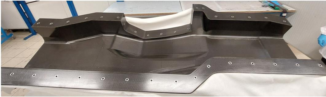
Figura 3.53: Semistampo sinistro del telaio
