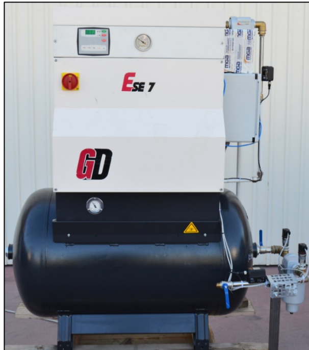
Figura 5.1: Il compressore a doppia vite ad iniezione d'olio in GD ESE 7
