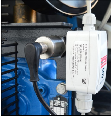
Figura 5.9: Posizione sensore vibrazioni
