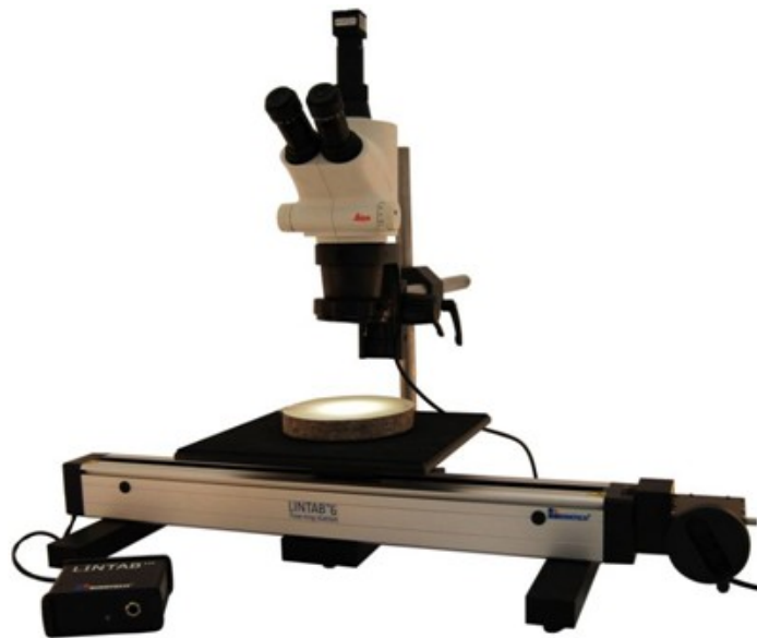
Fig. 2.5.1 Sistema ottico LINTAB (Rinntech)
