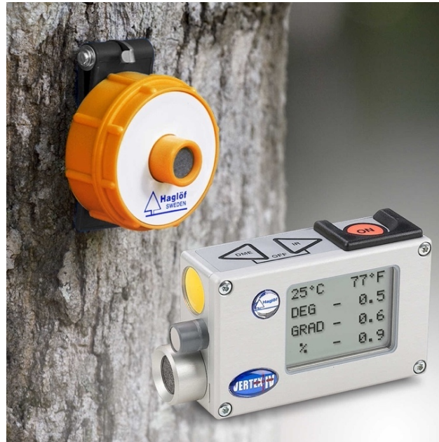
Fig 2.3.2 Ipsometro elettronico Vertex con relativo trasponder
