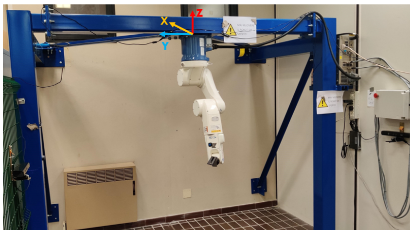
Figura 1.1: Robot Denso e sistema di riferimento.
