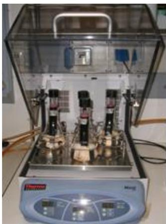
**Figura 3.** Matracchi in agitatore durante l'estrazione dei composti volatili
