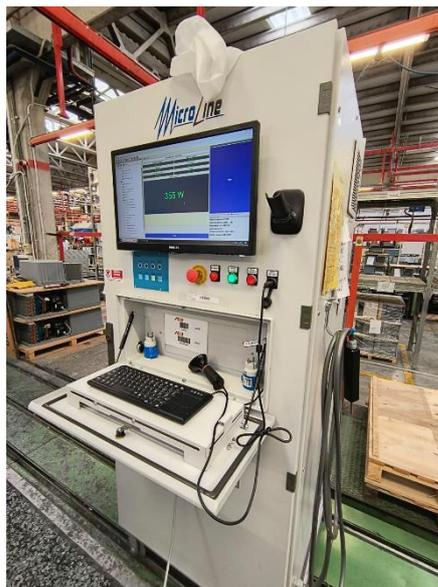
*Figura 12-Macchina per la prova elettrica "Microline"*
