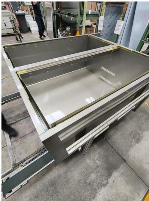
*Figura 8-Assemblaggio gusci e fissaggio del montante (1500)*
