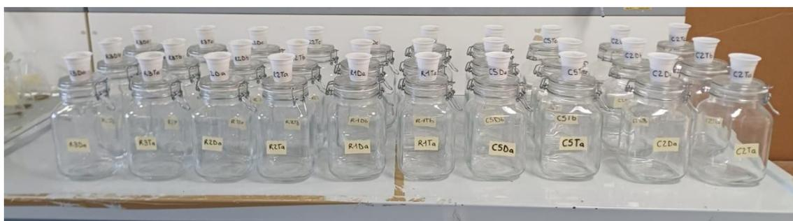
**Figura 3-5:** Sistemi ermetici per la respirazione microbica.
