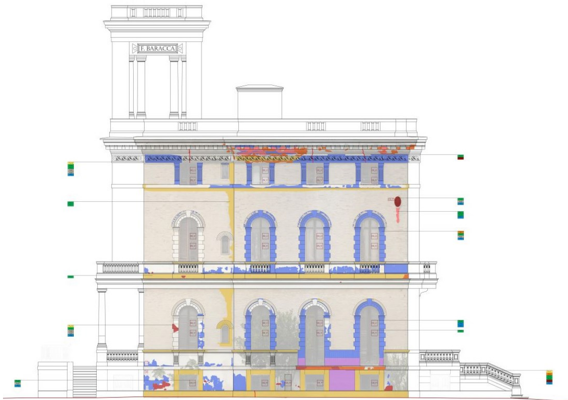
Figura 103. Analisi degradi Prospetto Est (Elab. Grafico Fabio Mirra, 2022)
