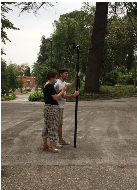
Figura 54-55. Presa fotogrammetrica tramite asta telescopica.
