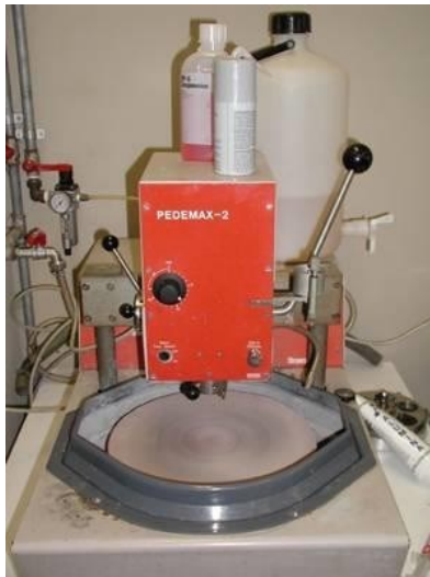
Figura 27 lappatrice per lucidatura meccanica
