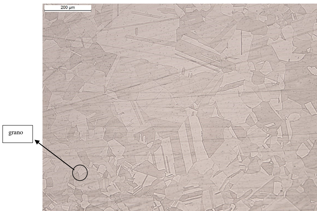
Figura 46 microstruttura barra 316L HT 10x1
