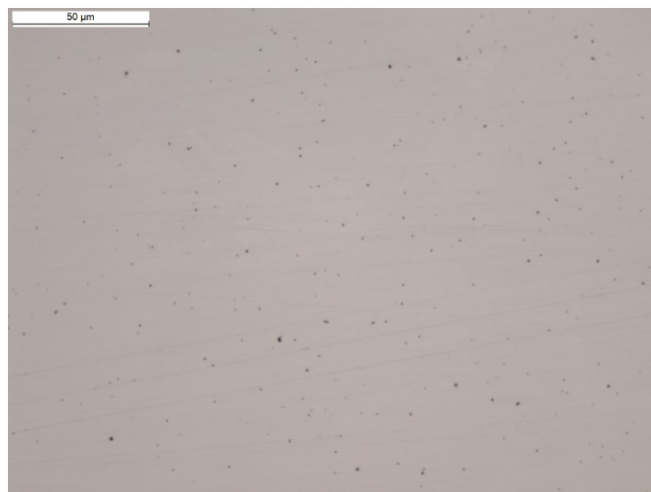
Figura 38 difetti barra 316L HT 50x1
