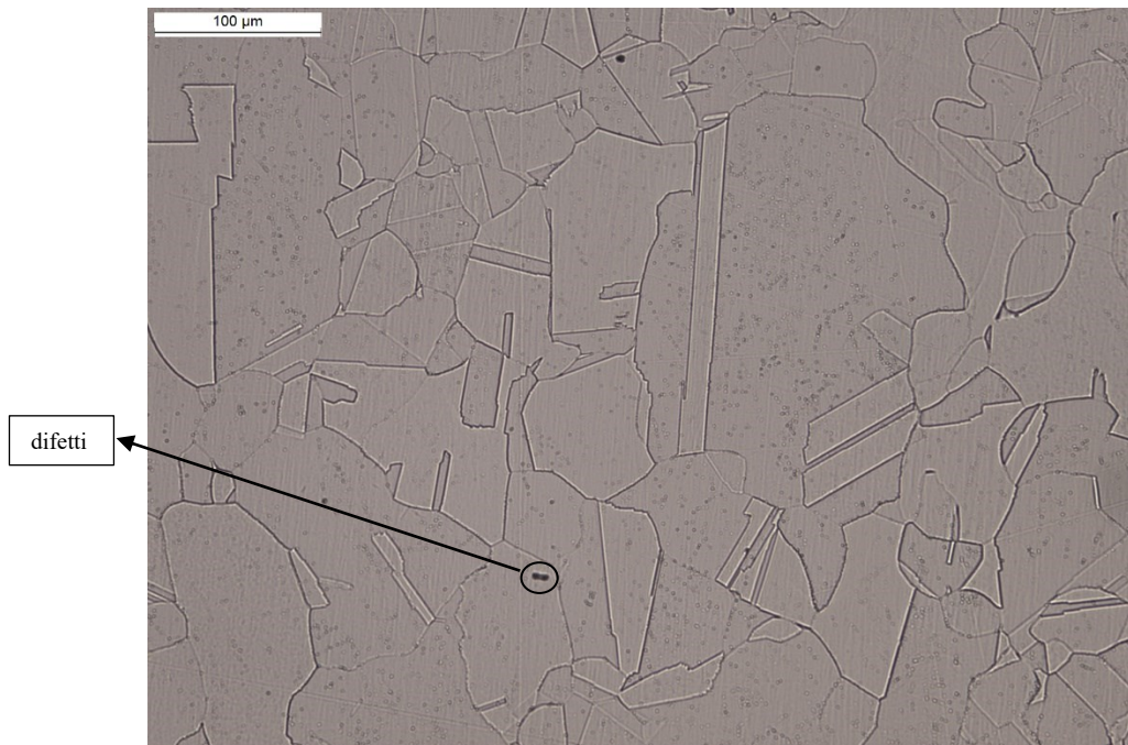
Figura 52 microstruttura 316L LPBF YZ HT
