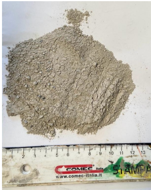
Figura 15: Formazione di agglomerati in MS con l'aggiunta di glicole dietilenico.
