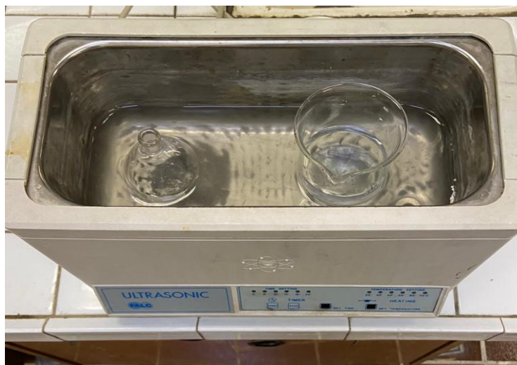
Figura 38: Pulizia del picnometro con bagno ad ultrasuoni.
