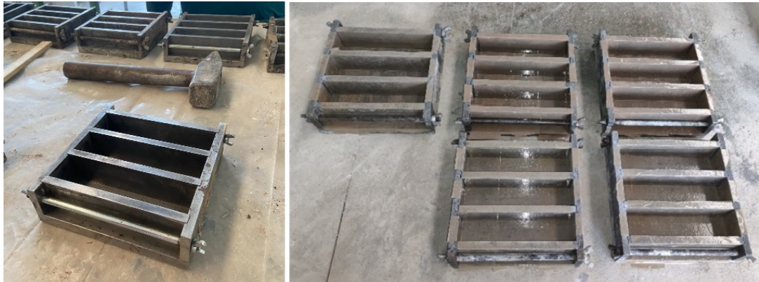
Figura 48: Cassero in acciaio (a); casseri in acciaio ricoperti con scotch (b).
