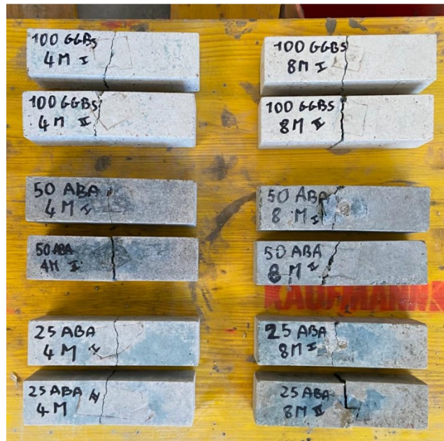
Figura 76: Provini 4M* e 8M* rotti a flessione.
