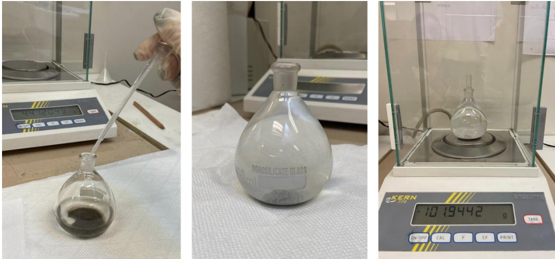
Figura 37: Uso della pipetta per riempire il picnometro (a); picnometro con acqua e polvere in sospensione (b); pesatura picnometro con acqua e polvere(c).
