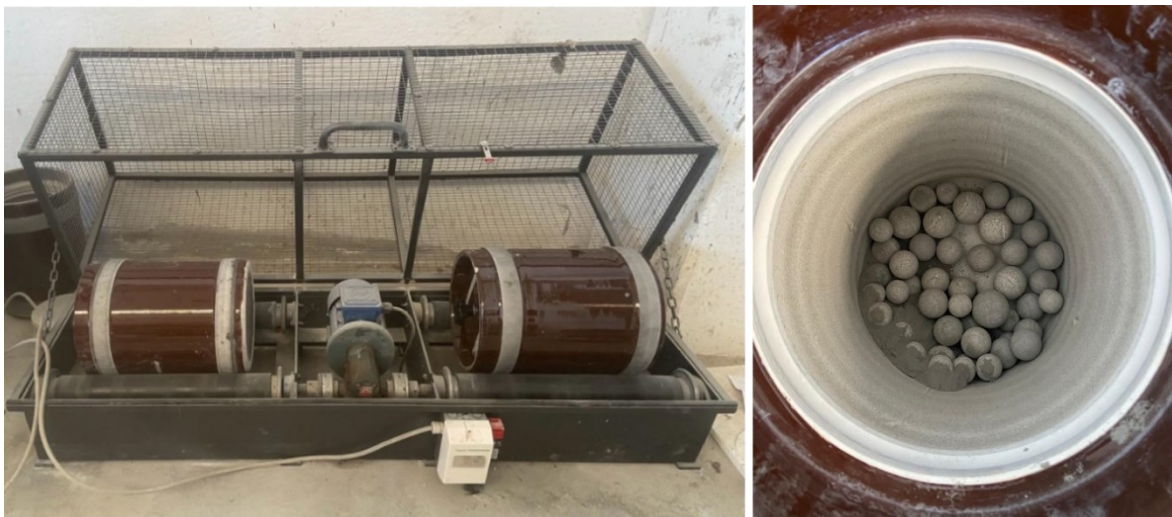
Figura 10: Mulino a biglie (a); mulino caricato con biglie di diverse dimensioni (b).
