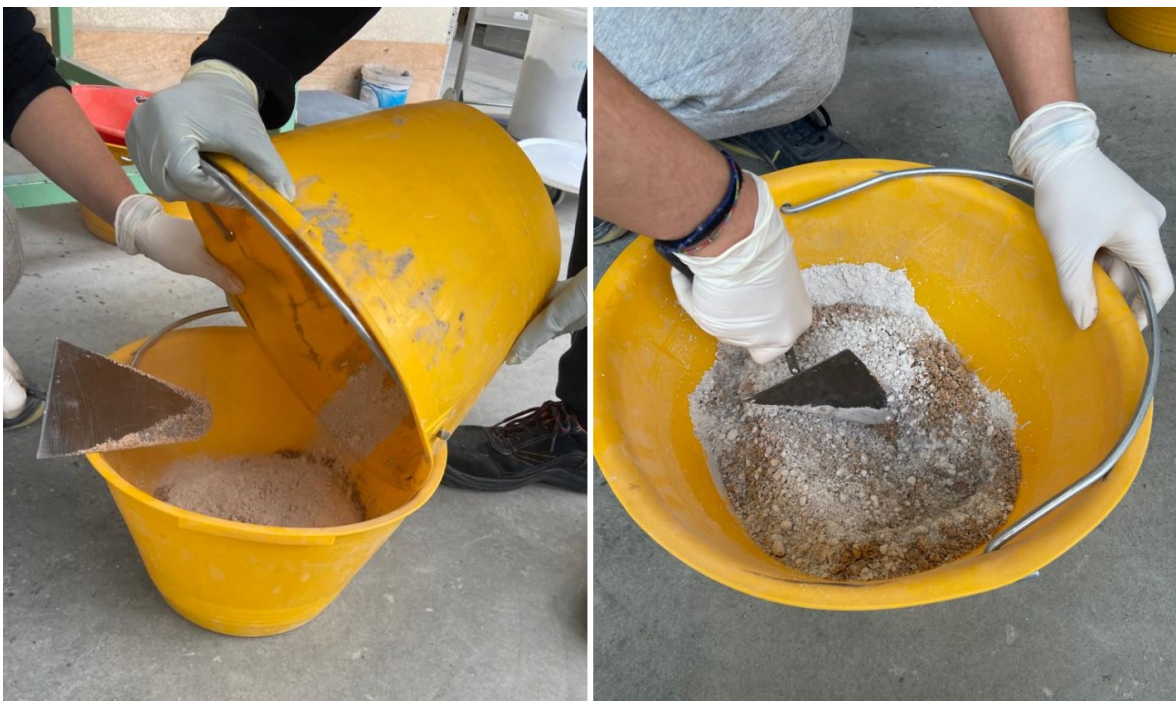
Figura 54: Unione delle polveri con la sabbia s.s.a. (a); omogeneizzazione della miscela (b).
