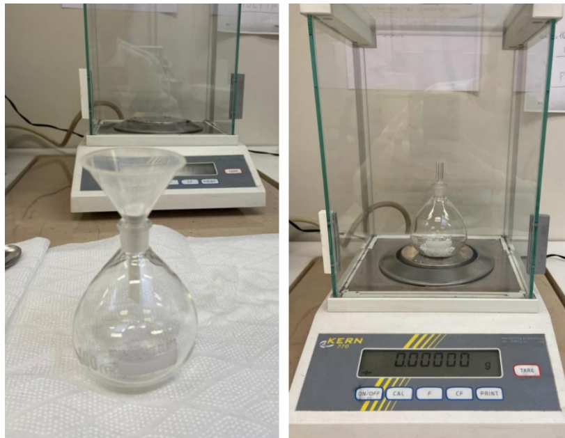
Figura 36: Inserimento polveri tramite imbuto (a); pesatura picnometro con polvere (b).
