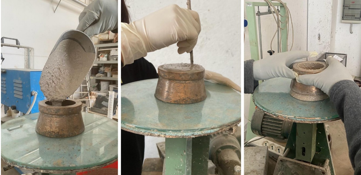
Figura 57: Riempimento dello stampo troncoconico (a); costipamento della malta (b); rimozione dello stampo troncoconico (c).
