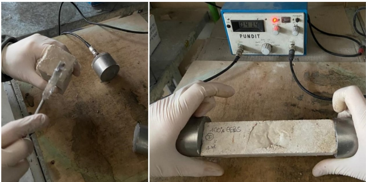
Figura 67: Posizionamento sottile strato di grasso sulle basi minori dei provini (a); misurazione del tempo di percorrenza delle onde ultrasoniche attraverso il provino (b).
