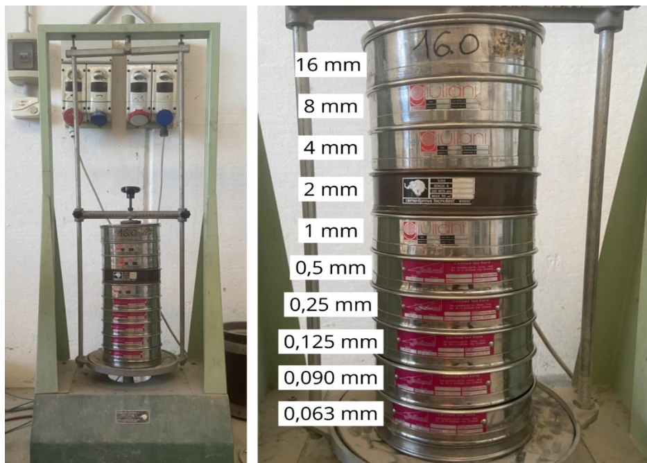
Figura 11: Setacciatrice (a); pila di setacci con relative aperture (b).
