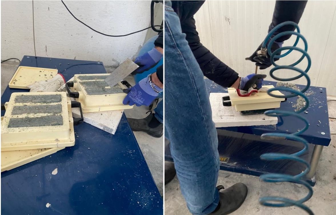
Figura 59: Limatura provini (a); scassatura tramite aria compressa (b).
