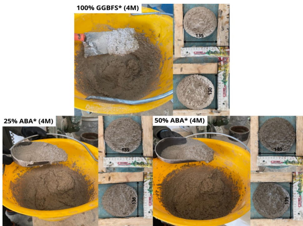
Figura 73: Spandimenti (D1 e D2 ) per 100%GGBFS* (4M), 25%ABA* (4M) e 50%ABA* (4M).
