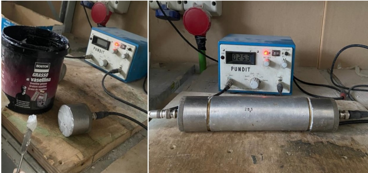
Figura 66: Posizionamento sottile strato di grasso sulle sonde (a); calibrazione dello strumento (b).
