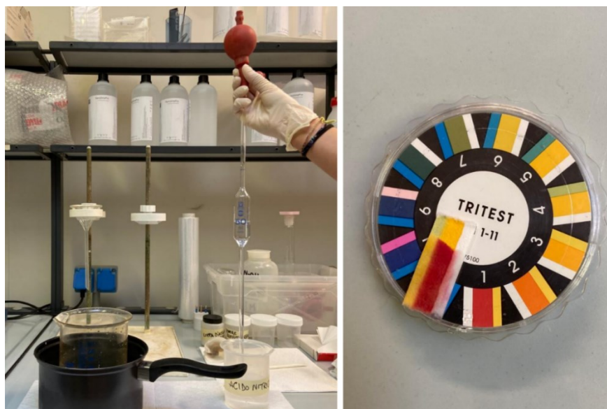
Figura 33: Acidificazione della soluzione alcalina (a); pH acido delle soluzioni verificato con la cartina tornasole (b).
