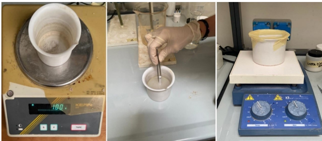
Figura 30: Peso della polvere (a); posizionamento dell'ancora magnetica (b); bicchiere di teflon caricato e posizionato sull'agitatore elettromagnetico (c).
