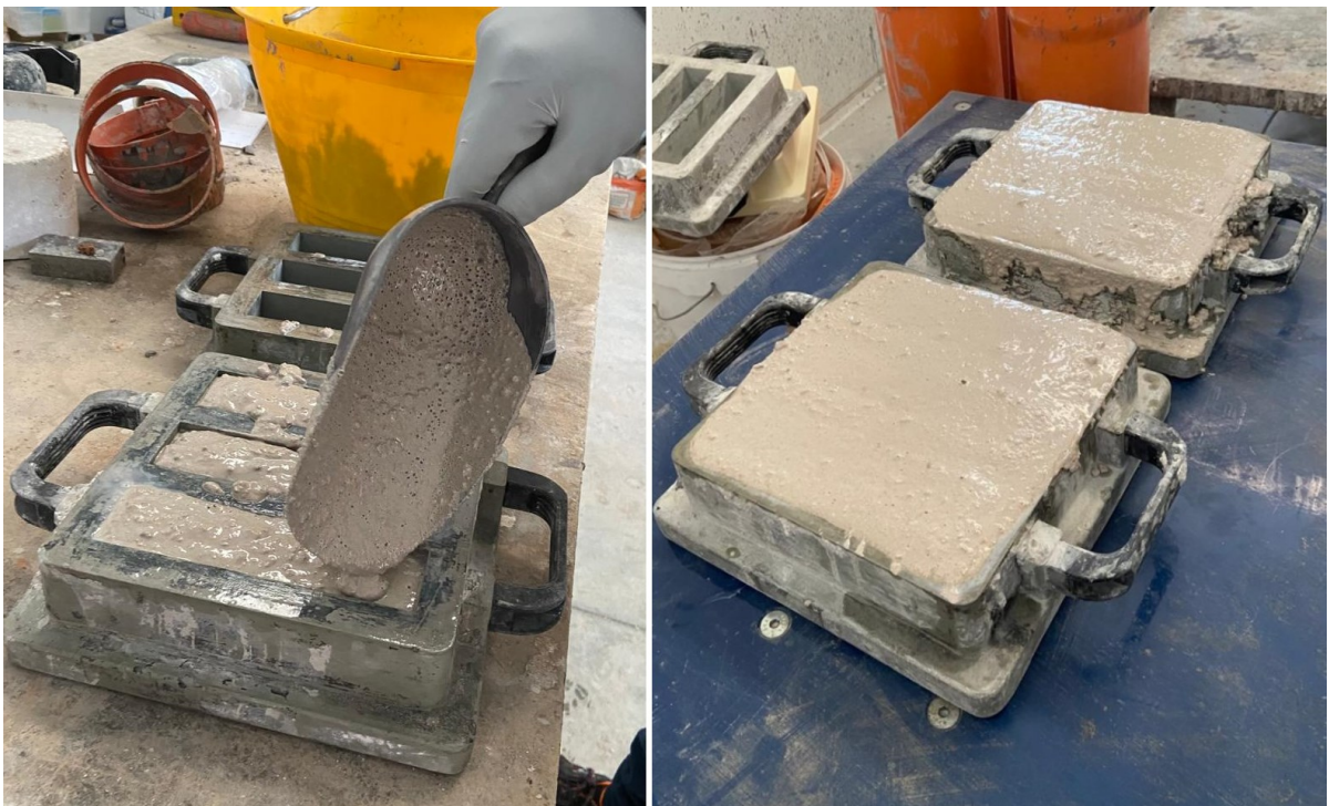
Figura 58: Getto dell'impasto all'interno del cassero (a); provini pronti per la fase stagionatura (b).
