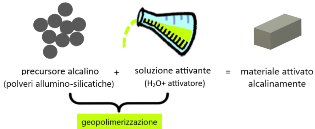
Figura 2: Schema di formazione degli alcali-attivati.
