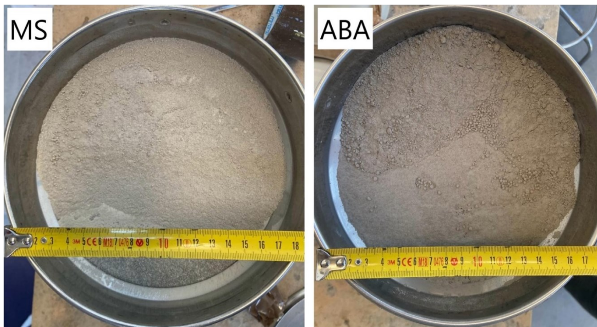
Figura 14: Formazione di agglomerati in MS e ABA al setaccio con apertura 500 \mu\text{m} .
