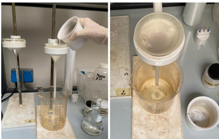
Figura 31: Filtrazione della soluzione (a); lavaggio del bicchiere (b).
