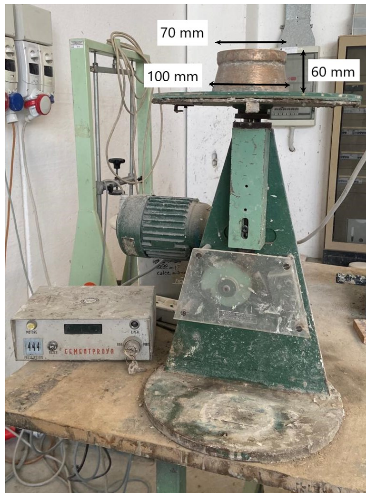
Figura 56: Tavola a scosse e stampo troncoconico (con misure).
