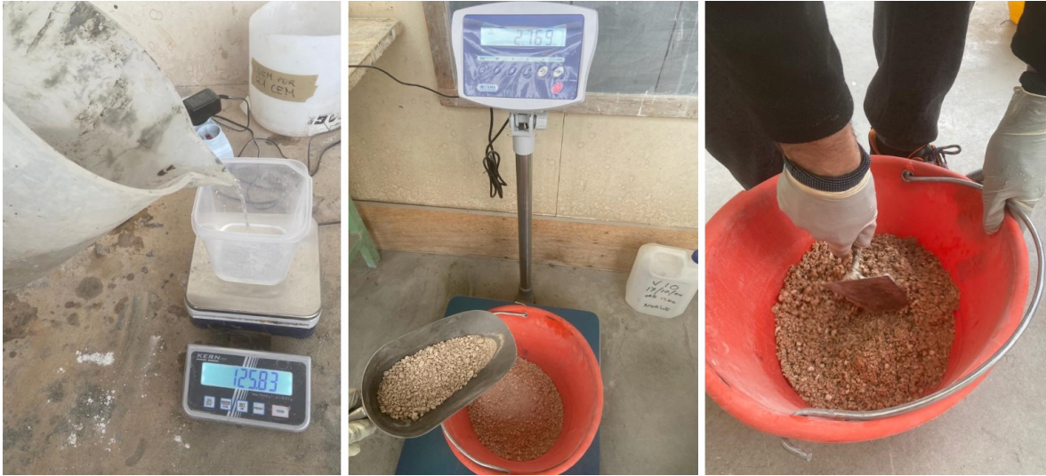
Figura 53: Pesatura acqua (a), pesatura sabbia (b), sabbia resa s.s.a (c).
