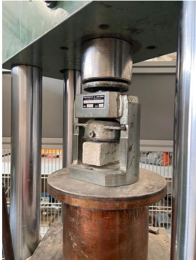
Figura 65: Setup di prova a compressione.
