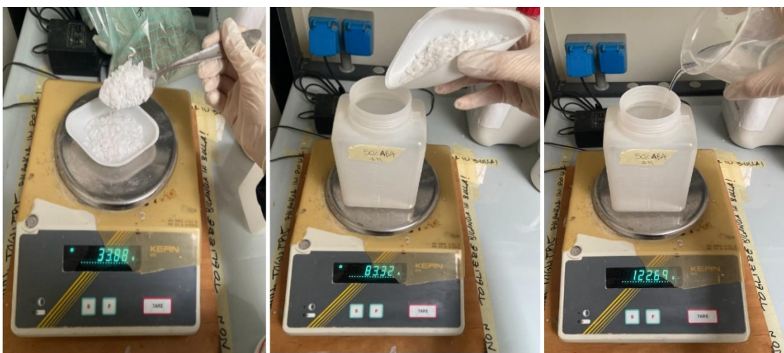
Figura 50: Pesatura della soda (a), posizionamento della soda nel contenitore che ospiterà la soluzione alcalina (b); pesatura acqua (c).
