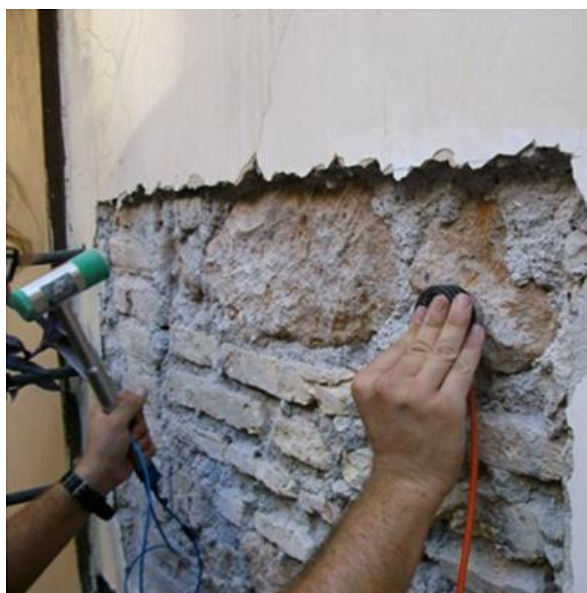
Figura 1.12 : Prova sonica su muratura su cui è stato rimosso lo strato di intonaco
