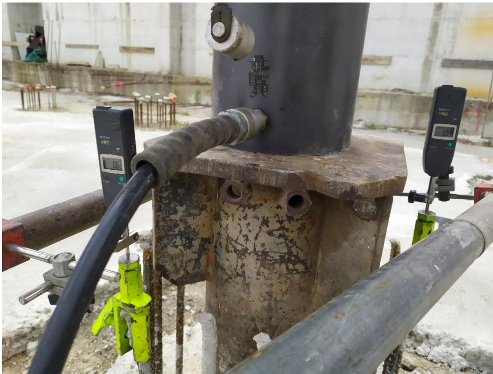
Figura 5.9 : Particolare del montaggio dei comparatori a 120°
