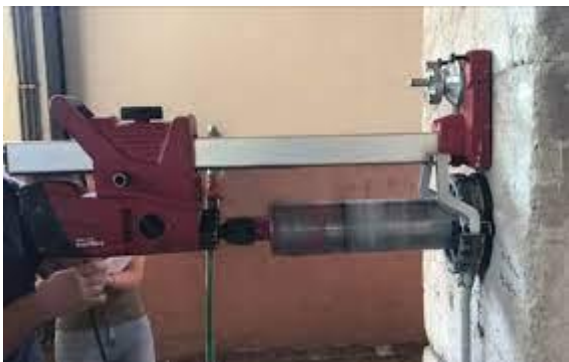
Figura 1.21: Carotaggio di un elemento in calcestruzzo armato Figura 1.22 : Test colorimetrico della carbonatazione
