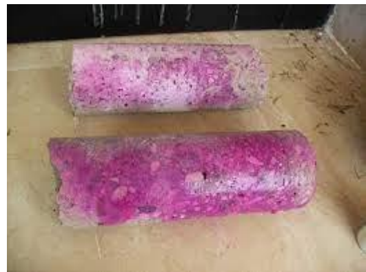
Figura 1.21: Carotaggio di un elemento in calcestruzzo armato Figura 1.22 : Test colorimetrico della carbonatazione
