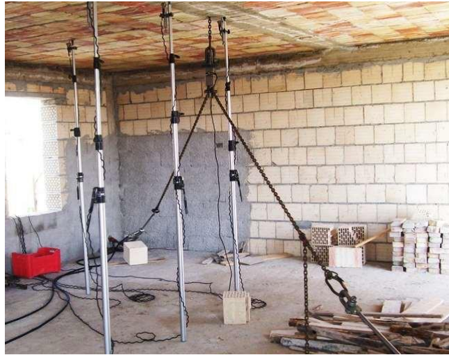
Figura 2.9 : Prova a tiro
