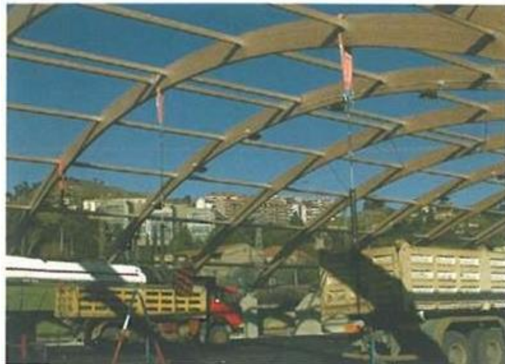
Figura 2.10 : Prova a tiro su capriate in legno
