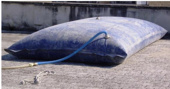
Figura 2.2 : Materasso d'acqua per generare il carico
